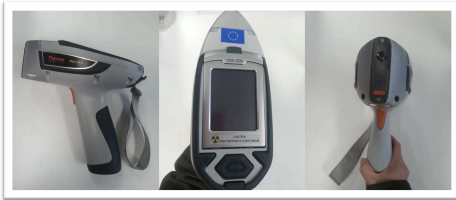
KUVA 5. Lyijypitoisuuksia mitattiin Niton XL3t GOLDD+ -analyssaattorilla (kuvan omistaja: Maarit Luoranen)
