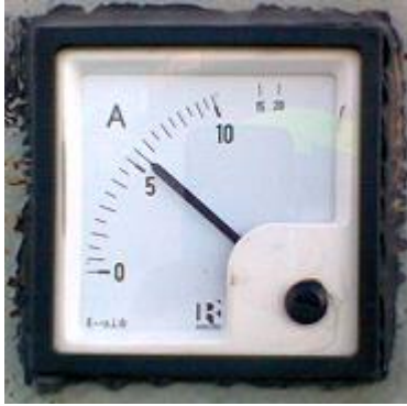
KUVA 7. Sillan vetomoottorin virtamittari
