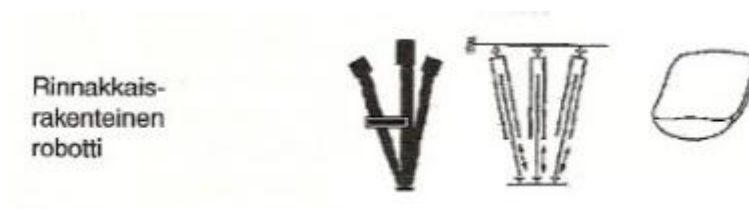
Kuva 5. Rinnakkaisrakenteisen robotin rakenne, kinemaattinen kaavio ja työalue [3, s. 12].
