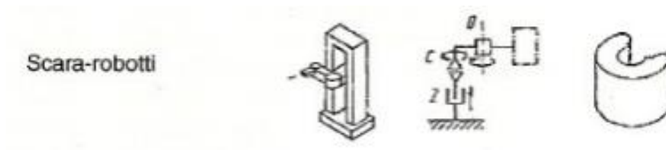
Kuva 3. Scara-robotin rakenne, kinemaattinen kaavio ja työalue [3, s. 12].
