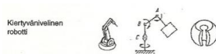
Kuva 4. Kiertyvänivelisen robotin rakenne, kinemaattinen kaavio ja työalue [3, s. 12].
