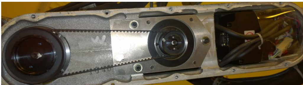
Kuva 9. Erään robotin voimansiirto hammashihnalla.
