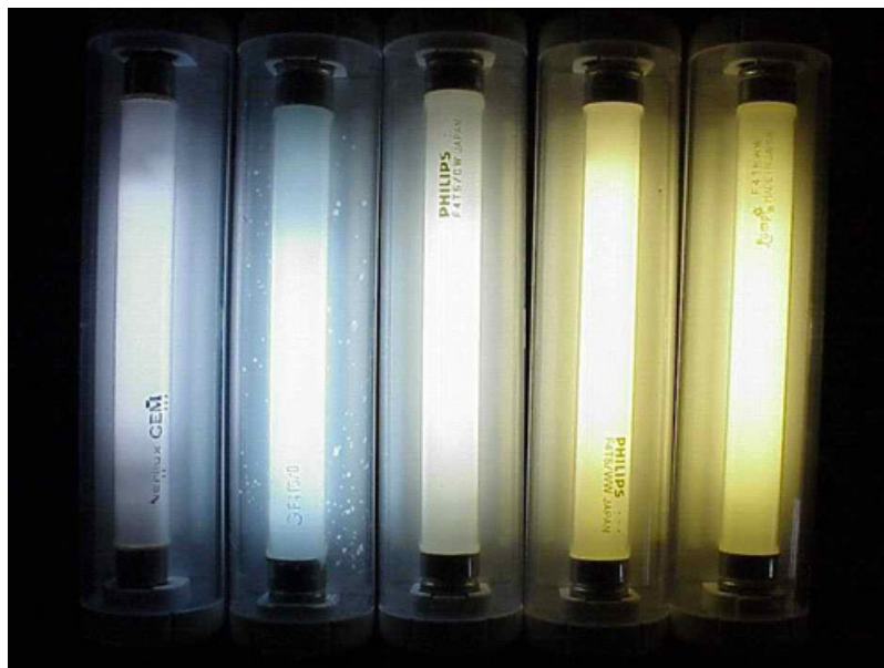
Kuva 13 Värilämpötilaltaan erilaisia loisteputkia
