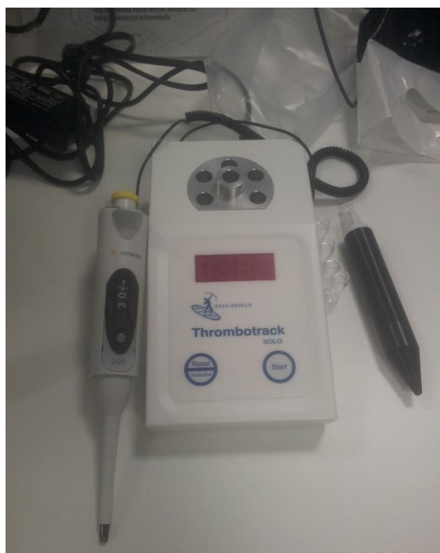
Kuva 5. Thrombotrack Solo – hyytymisanalysaattori (Tapiola 2015.)
