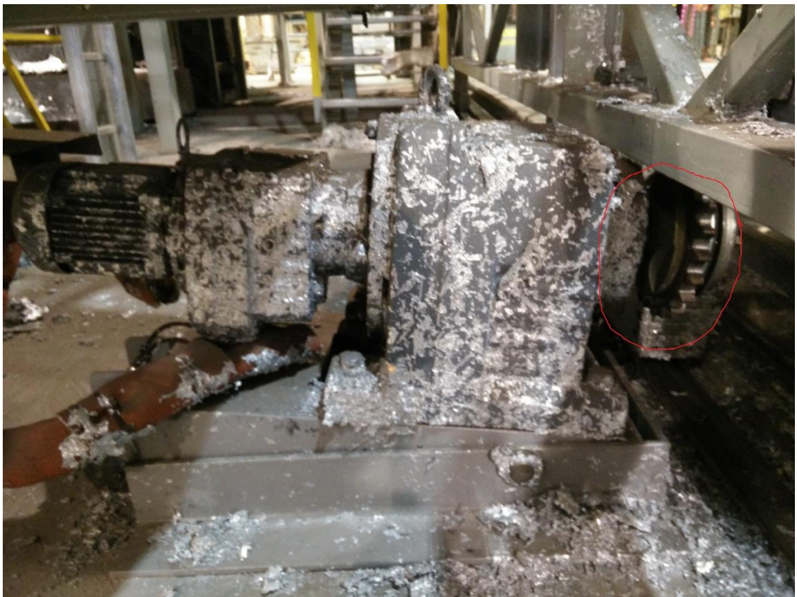
KUVIO 20. Syöttörännin siirron hammaspyörät
