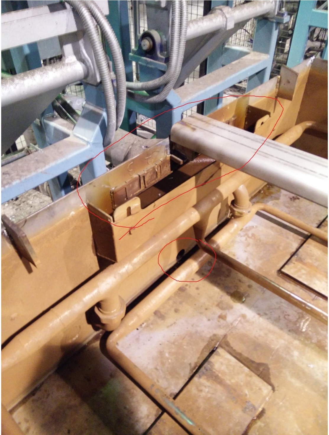
KUVIO 19. Jäähdytyslaitteen imulinjat
