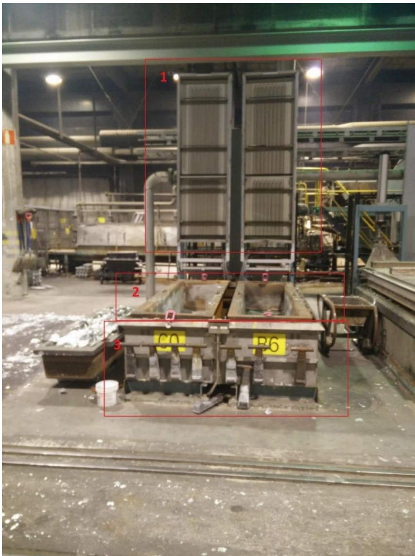
KUVIO 9. Kokillit (2), jäähdtyysallas (3) ja lämpökannet (1).
