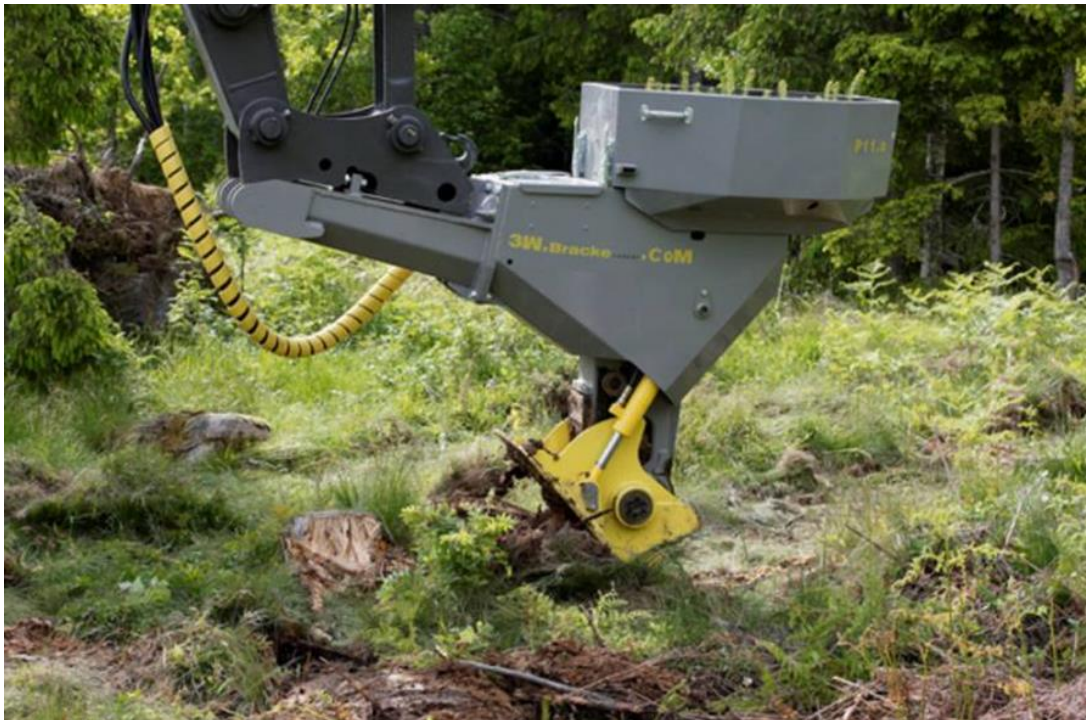
Kuva 2. Bracke- merkkinen laikkumätästys -ja istutuslaite kiinnitettyä kaivinkoneen puomiin (Puuntuottaja 2012).
