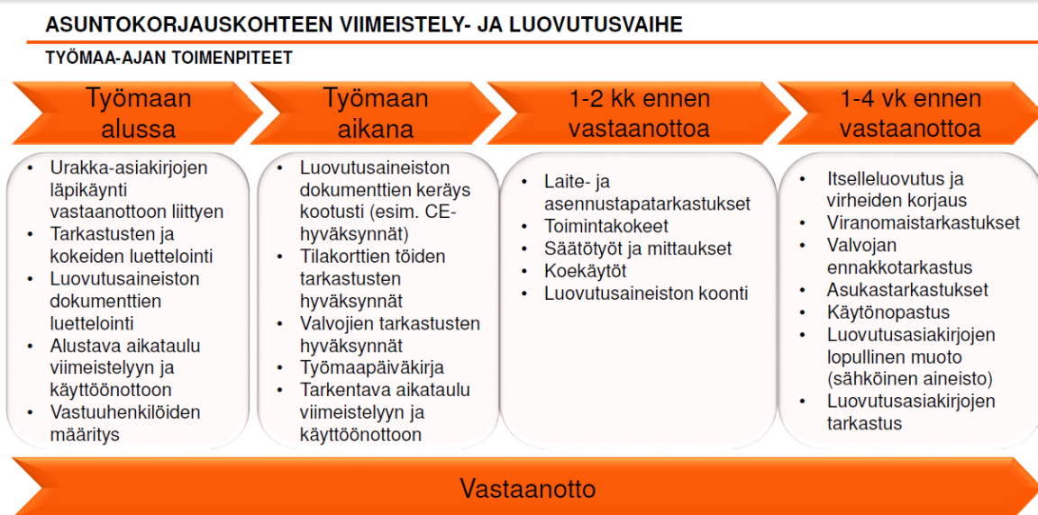
Kuva 10. Asuntokorjauskohteen viimeistely- ja luovutusvaiheen työmaa-ajan toimenpiteet
