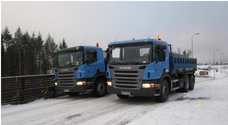
KUVA 15. Koekuormituksessa käytetyt ajoneuvot, kuormitustapaus Tervassilta 01 (Kuva: Heli Viljanen 2016)
