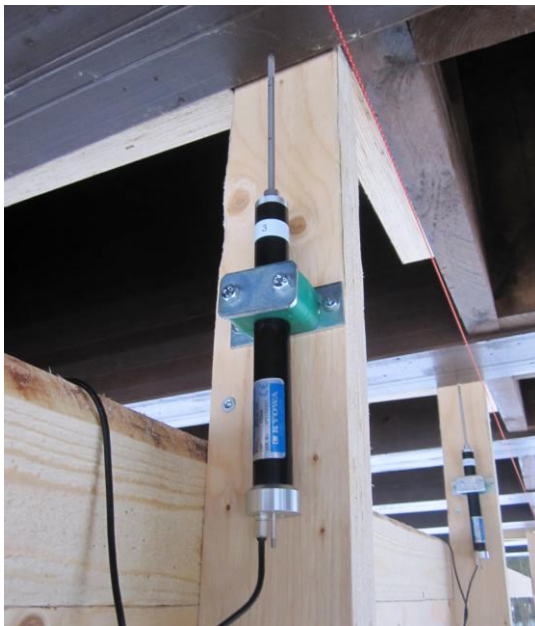
KUVA 16. Siirtymäanturi asennettuna siltapaikalle (Kuva: Heli Viljanen 2016)
