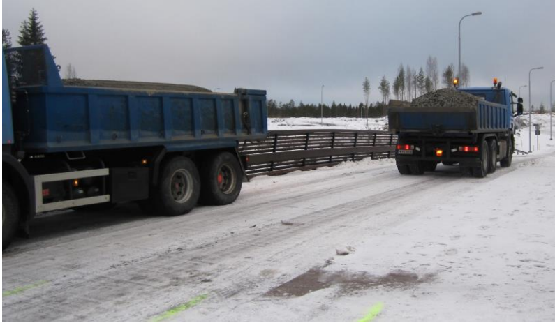
KUVA 21. Kuormitustapaus Tervassilta 03 (Kuva: Heli Viljanen 2016)
