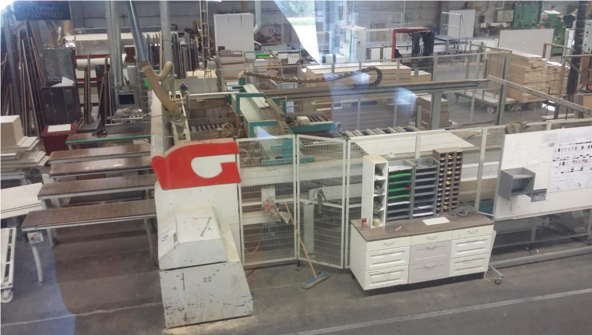
KUVA 4. Giben-paloittelusaha, takapuolisella levynsyötöllä ja etupuolisella pöydällä
