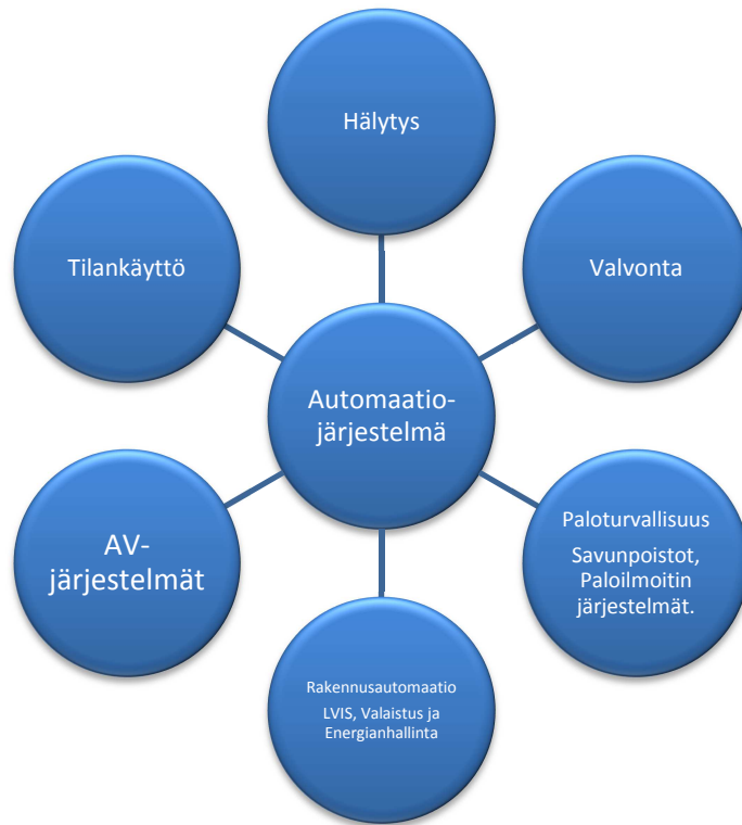
Kuva 1. Automaatiojärjestelmään liittyviä osajärjestelmiä
