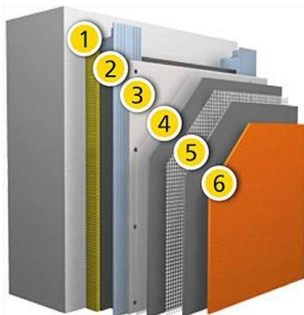
Kuva 10. Järjestelmäkuvaus Tuulettuvasta levyrappauksesta (26.)
