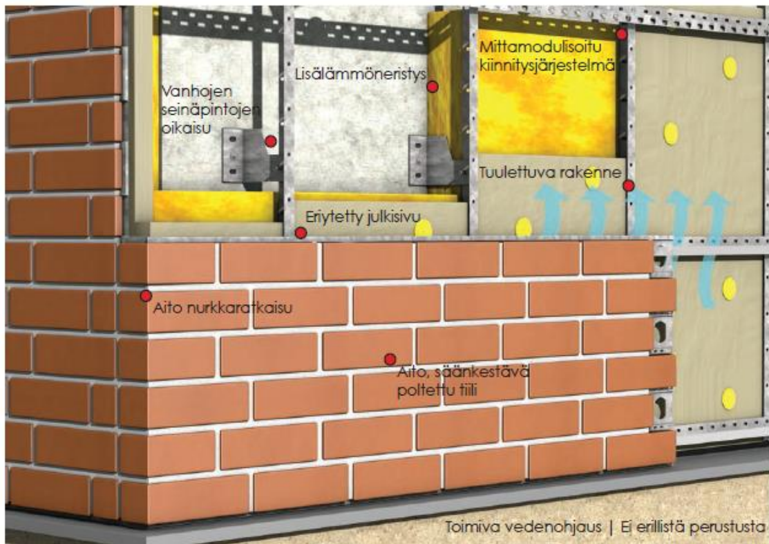
Kuva 9. Esimerkki tuulettuvan tiiliverhousjärjestelmän rakenteesta (11, 7.)
