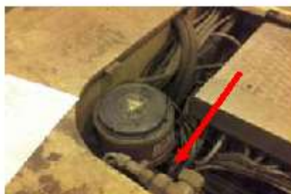
Kuva 4. Rasvasäiliö. Nuolella merkitty rasvan täyttö nippa
