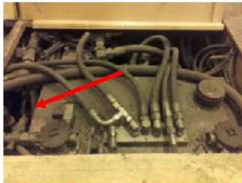
Kuva3. Hydrauliohjain tason tarkastus säiliön sivussa
