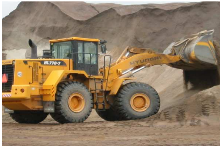
Kuva 11. Kauhakuormaaja, jolla maa-ainesten siirtely kauempaa on nopeampaa
