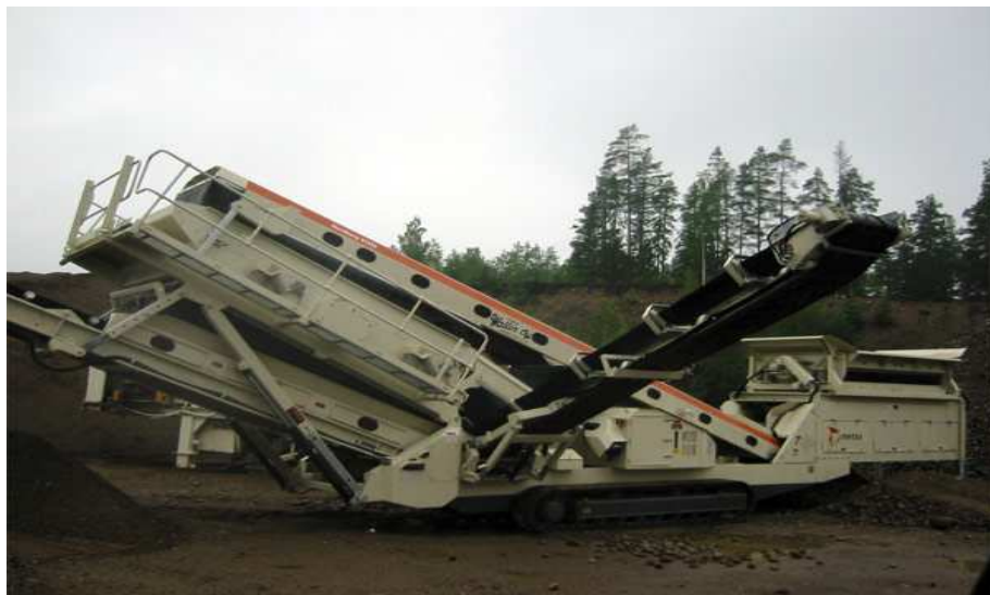
Kuva 13. Seulontalaitos, jolla kiviainekset pystytään seulomaan raekooltaan omiin kasoihinsa [14.]
