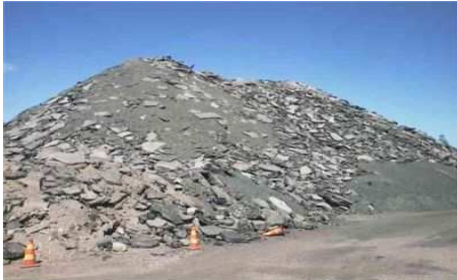
Kuva 14. Asfaltinpalat läjitetään kasoihin ennen murskausta. Auringonpaiste toimii hyvänä esimurskana asfaltinpalloille. [18.]
