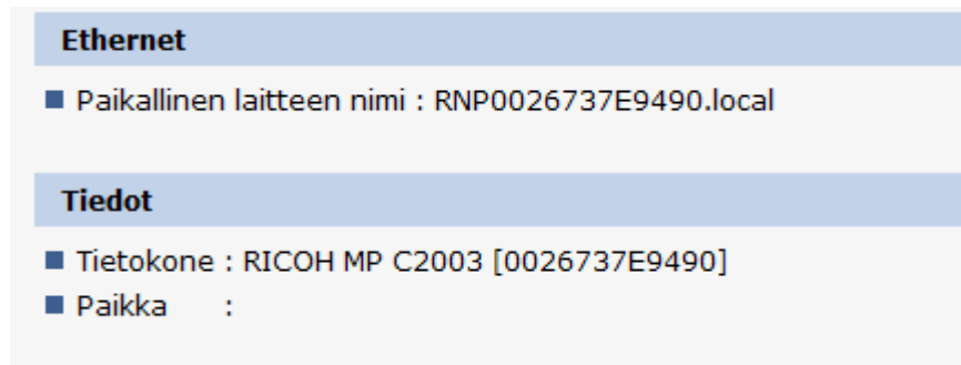
Kuva 9. Ricoh-tulostimen MAC-osoite internetselaimen kautta hallintakäyttöliittymällä tarkasteltuna.
