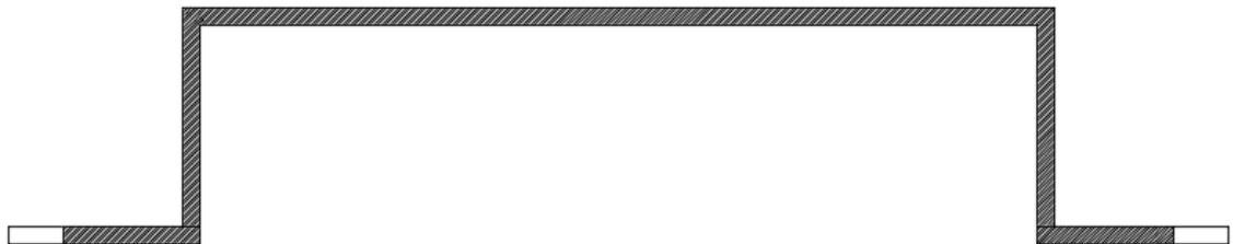
KUVA L1/11 HATTUORREN TEHOLLINEN POIKKIPINTA-ALA TUULENIMUN AIHEUTTAMA TAIVUTUSTA VASTAAN
