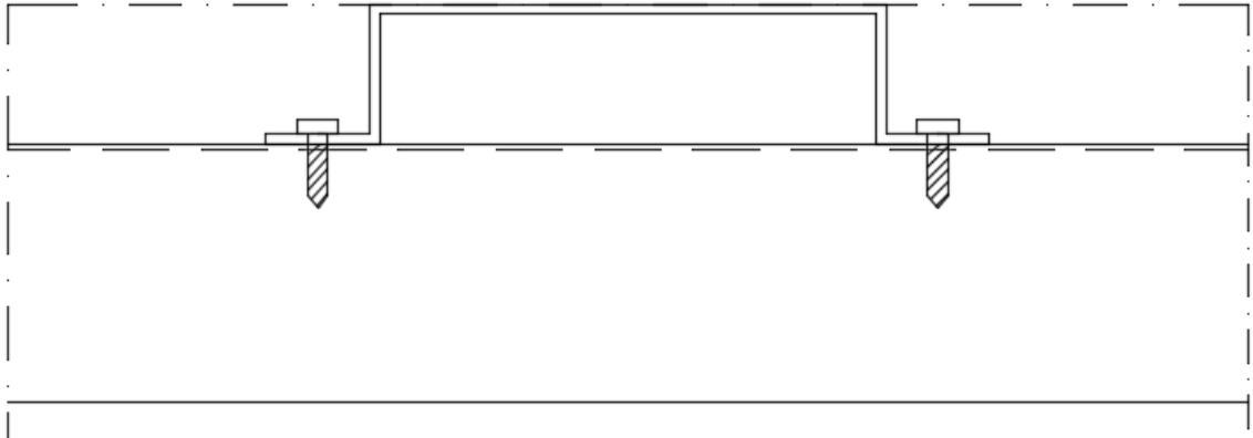
KUVA 24. HATTUORREN KIINNITYS VAAKAORTEEN
