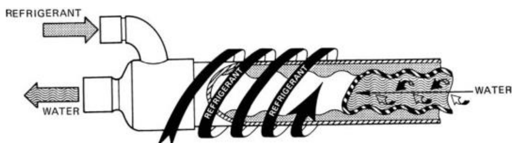
Kuvio 8. Koaksiaalilauhdutin. Lauhduttava vesi virtaa putkessa, jonka ympärille kylmäaineputki on kierretty. (Ref-wiki, [viitattu 3.2.2016]).
