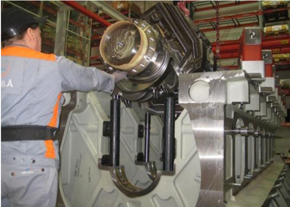
KUVA 8. Kampiakselin asennus moottorin runkokäytävän
