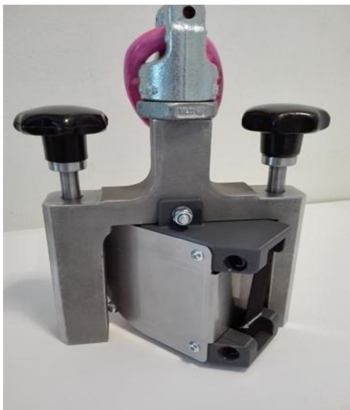
KUVA 30. Runkolaakerisatulan laakerinpalanpidikkeen toinen protoversio
