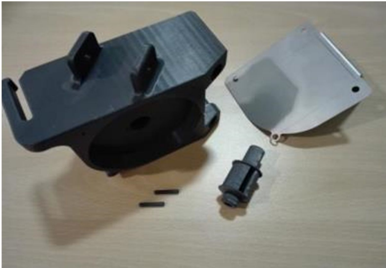
KUVA 27. 3D-tulostetut osat ensimmäiseen protoversioon: runko, akseli ja nauhan pidintappi, oikealla jousen suoja Levy
