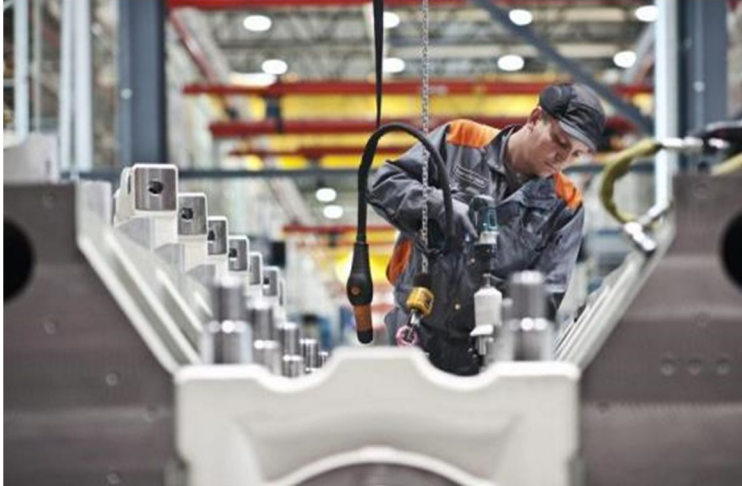
KUVA 9. Runkolaakerisatuloiden asennus runkokäytävän mittausta varten (7)
