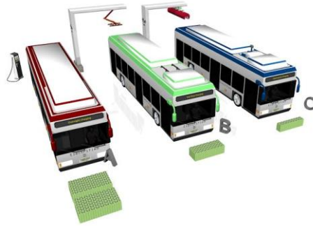
Kuva 7. Kuvassa A perinteinen yön yli-lataus, B käänteinen virroitin ja C virroitin [14]
