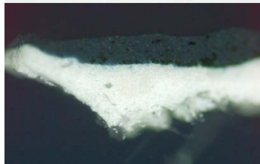
Tummansinisen värialueen poikkileikkausnäyte 100x suurennoksena, (alla) UV-valossa.
