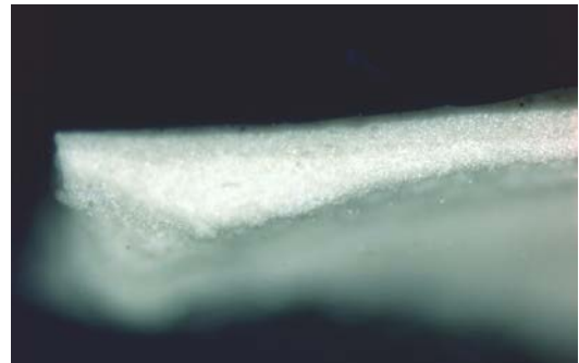
Harmaan värialueen poikkileikkausnäyte 100x suurennoksena UV-valossa.
