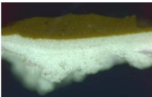
Keltaisen värialueen poikkileikkausnäyte 100x suurennoksena UV-valossa.
