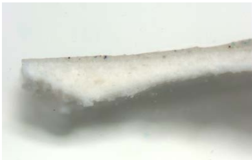
Harmaan värialueen poikkileikkausnäyte 100x suurennoksena.
