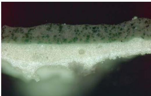
Turkoosin värialueen poikkileikkausnäyte 100x suurennoksena UV-valossa.
