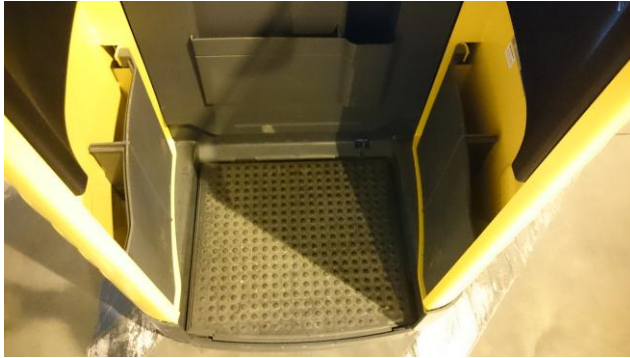
Kuva 19. Kiinteällä ajotasolla varustetun ERE 225 -mallin ajotaso ja säilytyslokerot
