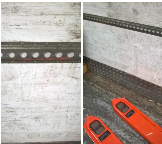
Kuva 24. Kuormatilan seinämä ja sidontakisko, johon on tarttunut maalia lavansiirtovaunusta
