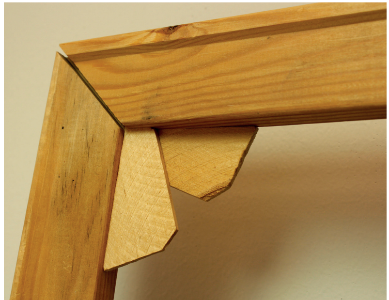
Kuva 26. Yksityiskohta kiilakehyksestä ja kiiloista.
