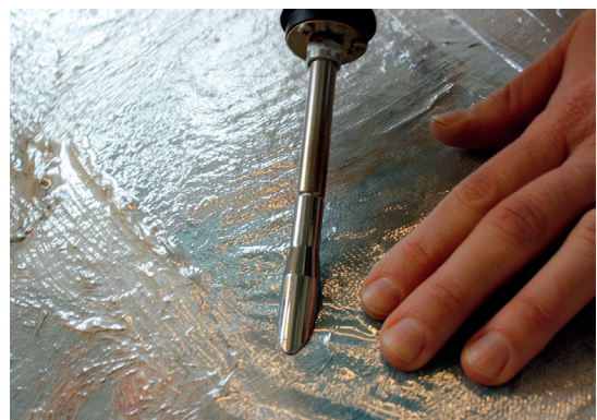
Kuva 52. Harjanteiden tasoitusta lämpölusikalla.
