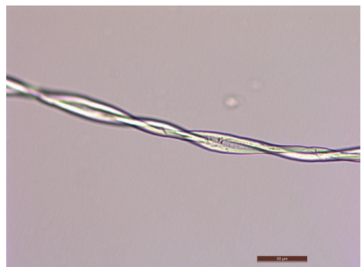
Kuva 33. Puuvillakuidun referenssinäyte. 200-kertainen suurennos.
