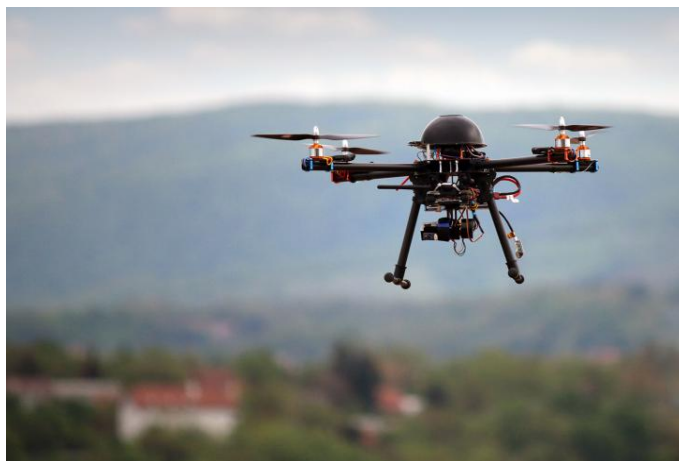
Figur 7. Drönare utgör exempel på teknik som använder sig av en PID regulator för att stabilt hållas i luften. (Illustrerad vetenskap, 2016)
