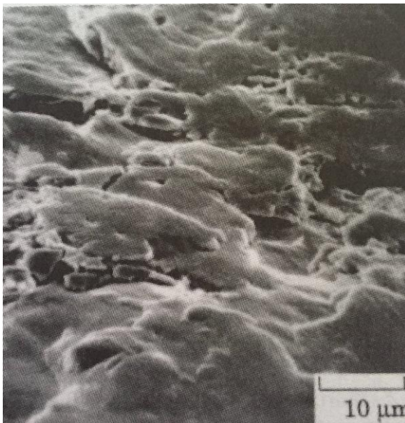
Kuva 26. Abrasiivisesti kulunut pinta, jossa on kyntämisen jälkiä. [2, s. 110]
