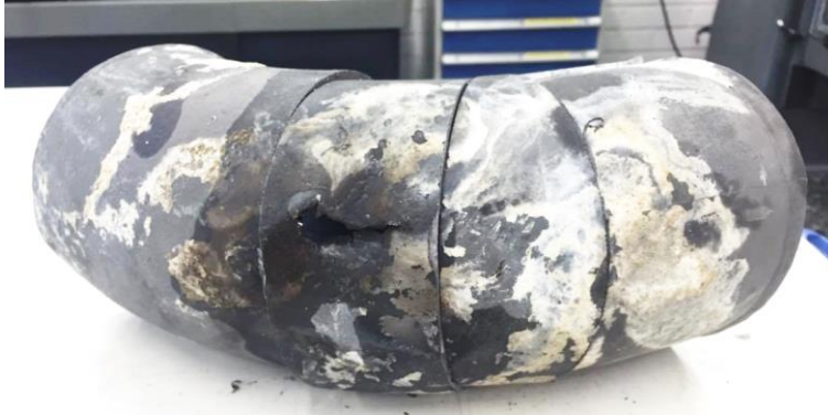
Kuva 16. Putken 2 sahatut osat.
