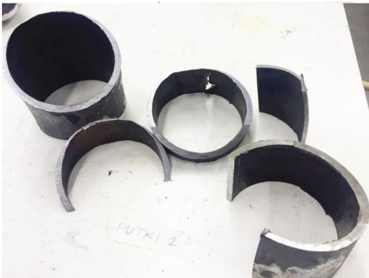
Kuva 17. Putken 2 sahatut osat.
