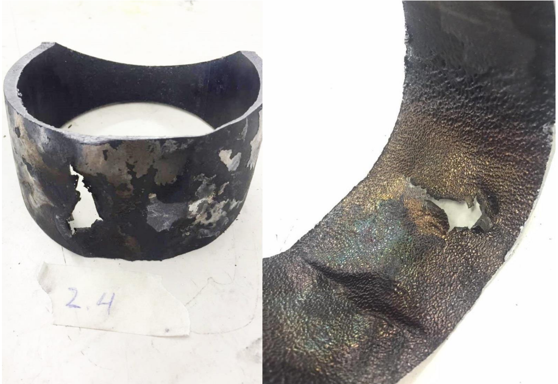
Kuva 21. Putken 2 osa 2.4, joka on sahattu. Läpireikä.
