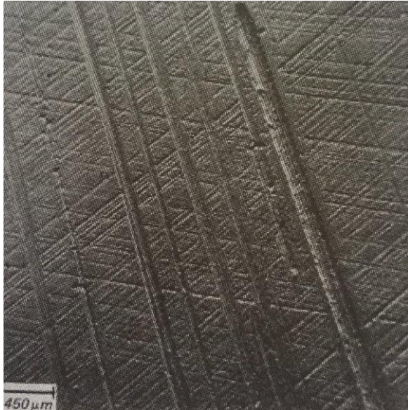
Kuva 26. Abrasiivisesti kulunut pinta, jossa on kyntämisen jälkiä. [2, s. 110]
