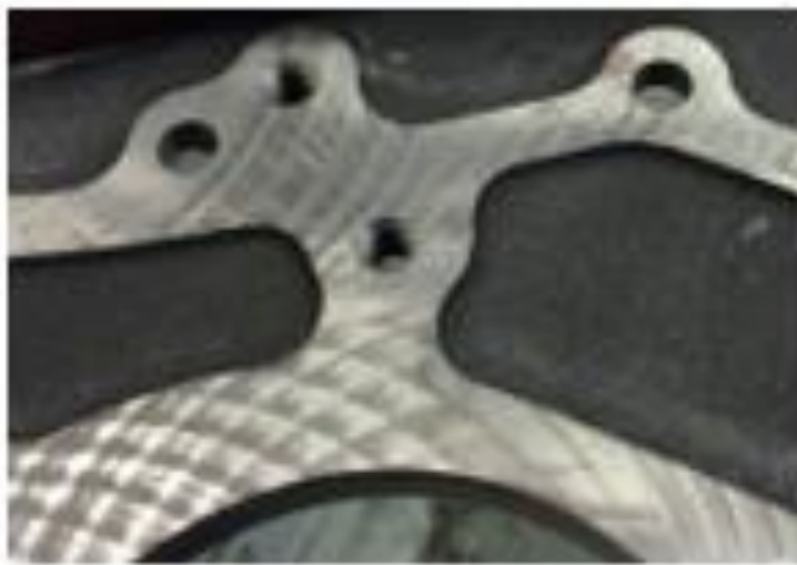
KUVA 10. Hammaspyöräkotelon tiivistepinta (Jänkävaara & Koskisuu 2014).
