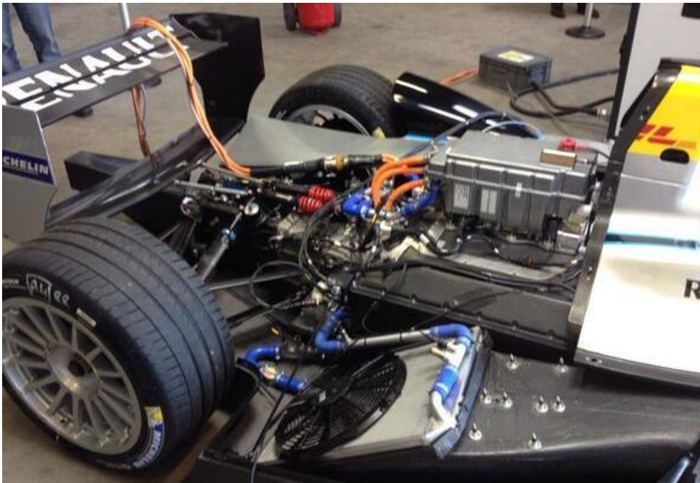
Figur 14. Motorutrymme för en Formula E bil (Current E, 2014).
