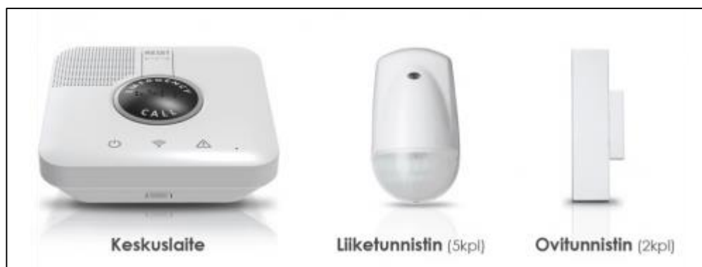
Kuva 1. OMAseniori-turvapalvelun fyysisesti asennettava laitteisto [37.]
