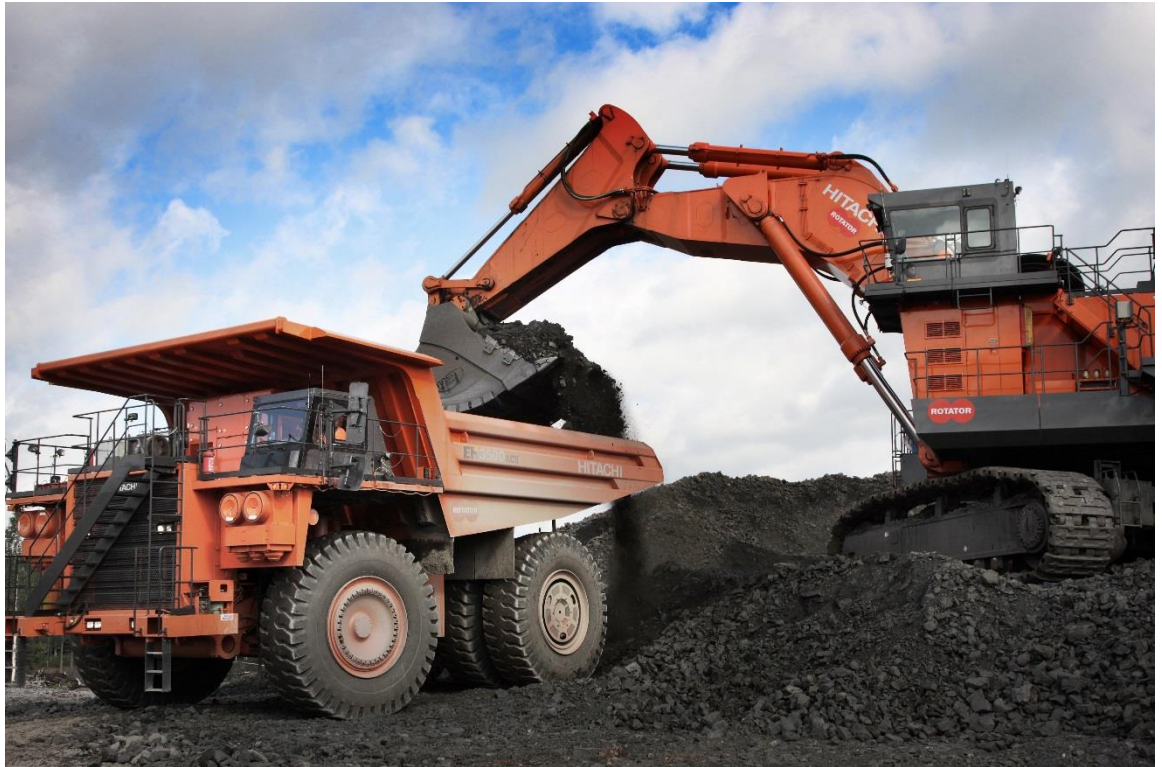
Kuva 2. Kiviauton lastaus kaivinkoneella (3)
