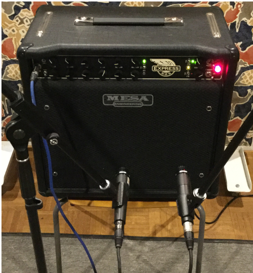
Kuva 13. SM57 kartion keskellä (ääninäyte 9) ja SM57 kartion reunalla (ääninäyte 10)
