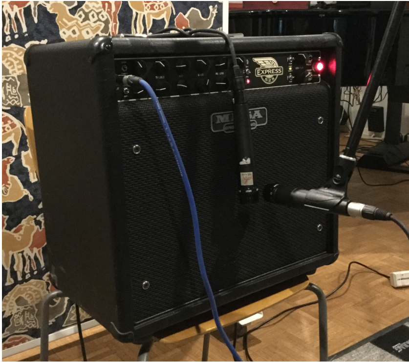
Kuva 15. SM57 kantokahvasta roikotettuna ja SM57 osoitettuna kaiutinkartion keskelle
