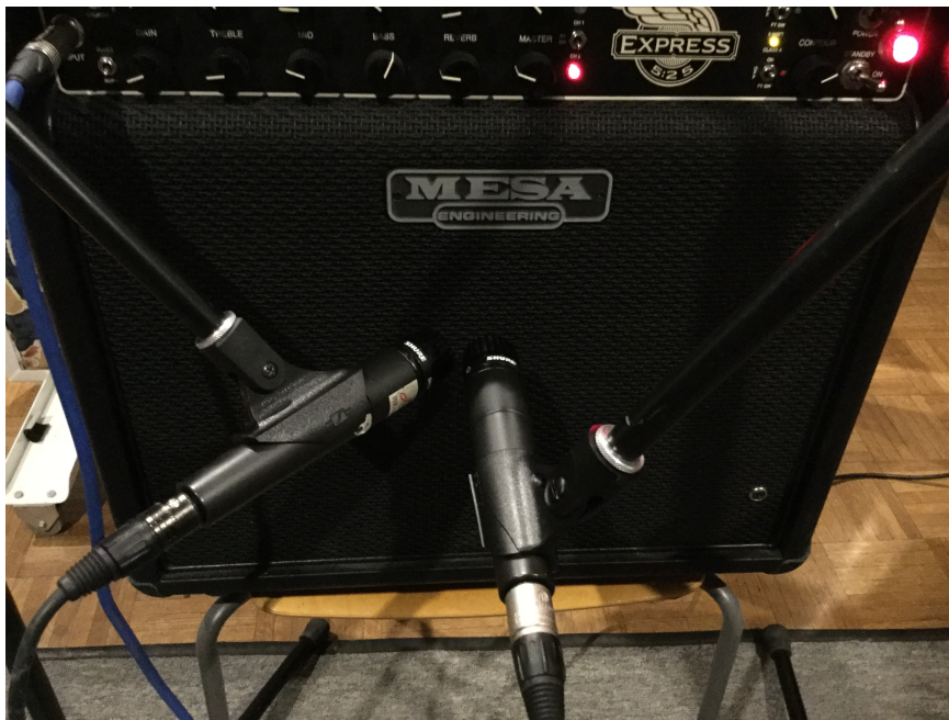
Kuva 14. SM57 kartion keskellä (ääninäyte 11), SM57 45-asteen kulmassa (ääninäyte 12), sekä molemmat yhdessä (ääninäyte 13)
