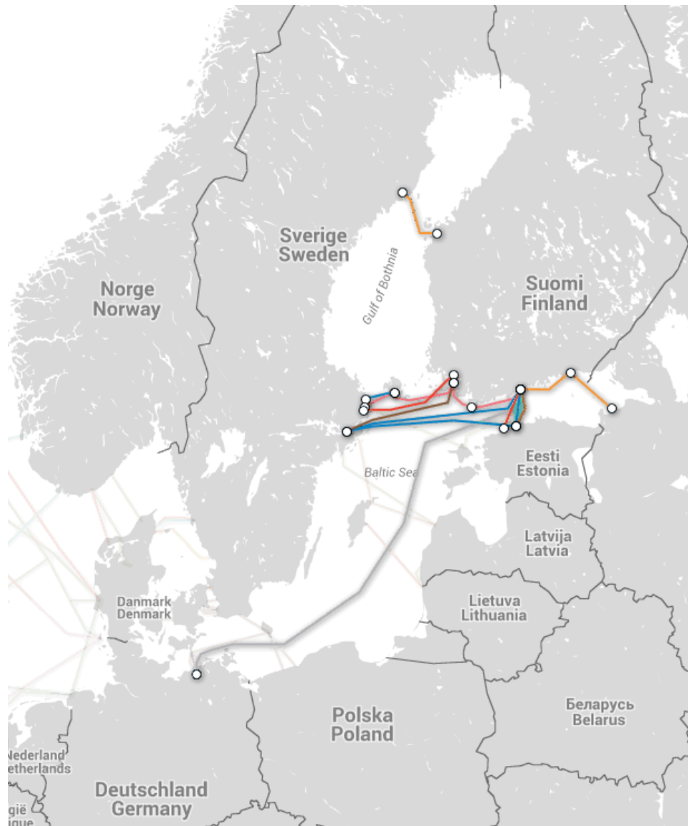
Kuva 1. Suomesta lähtevät merikaapelit yhdistävät Suomen internetiin. Harmaalla uusi C-Lion –merikaapeli. (Primetrica, 2016.)
