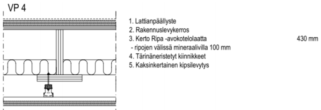
Kuva 6. Puukerrostalon välipohja ilman kelluvaa laattaa (Kylliäinen, 2015).
