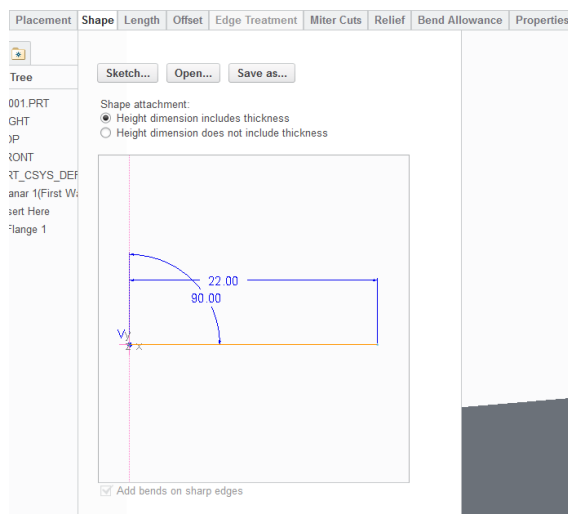
Kuva 114. Uuden laipan luontiin tarvittavat muotomäärittäykset.
