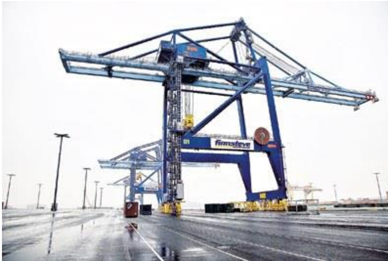
Kuvio 5. Ship to shore gantry crane (Valomerkki, 25.11.2008.)
