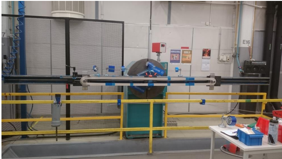
Kuva 2: Kelauspuomi sekä kelauspuomille kelattu valmis aihio.
