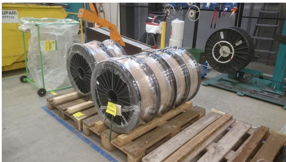
Kuva 3: Etualalla näkyvät kelausta odottavat kuparikelat puulavoillansa. Taustalla on yksi kela valmiina kelauskoneen akselilla 1.
