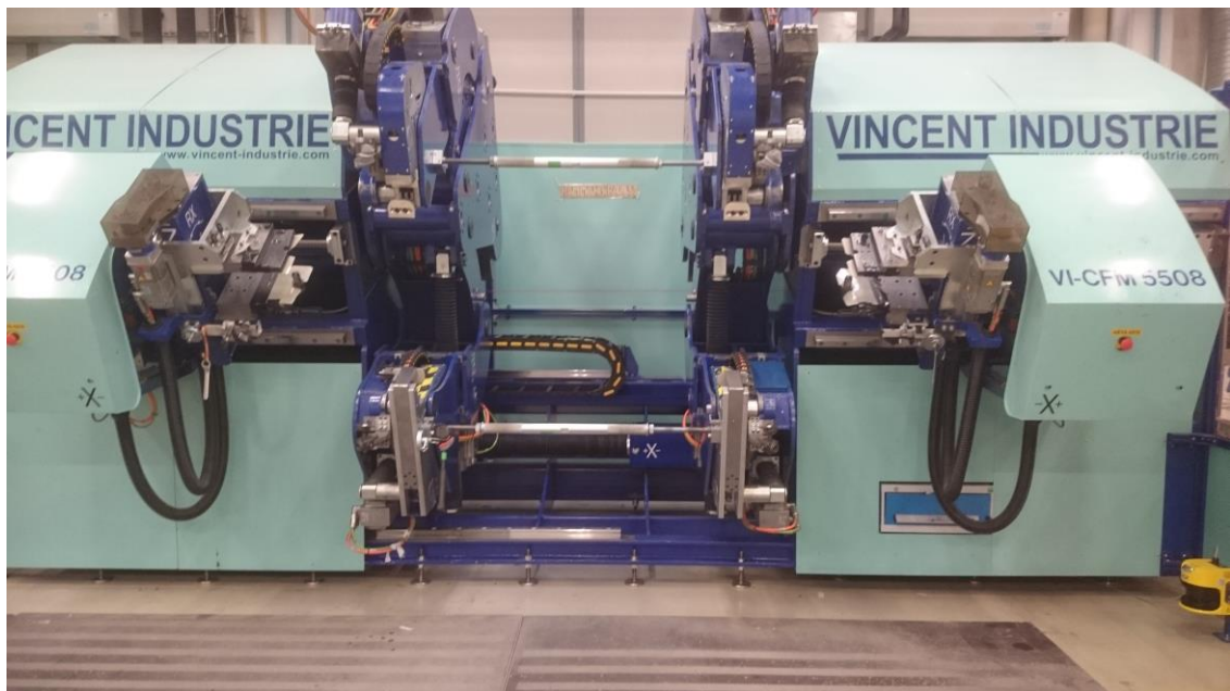
Kuva 5: Levityskone. Aihion päät tulevat molemmilla sivuilla näkyvien monimutkaisten kelkkojen sisäreunassa sijaitsevien tappien ympärille.
