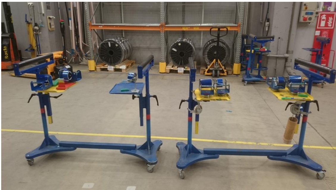
Kuva 18: Aihiot teipataan ja kuljetetaan levityskoneelle kuvassa näkyvien tasojen päällä. Pitkiä aihioita tehdessä tasot voidaan kiinnittää toisiinsa yhdeksi pitkäksi tasoksi.
