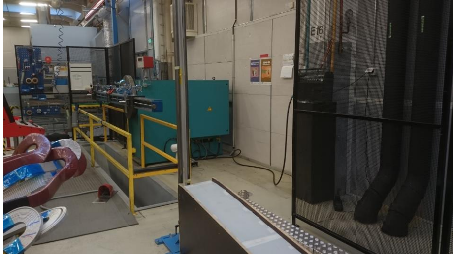
Kuva 17: Kuparilanka kulkee kelauspuomille kahden kuvan keskellä näkyvän metallisen pystytangon välistä.
