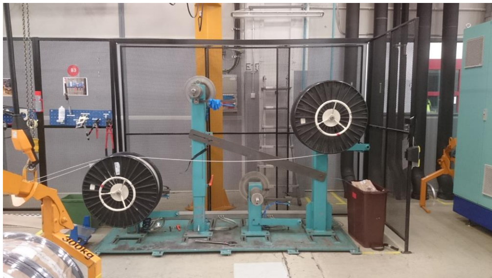
Kuva 16: Kelat valmiina kaksilankaisen aihion kelaukseen
