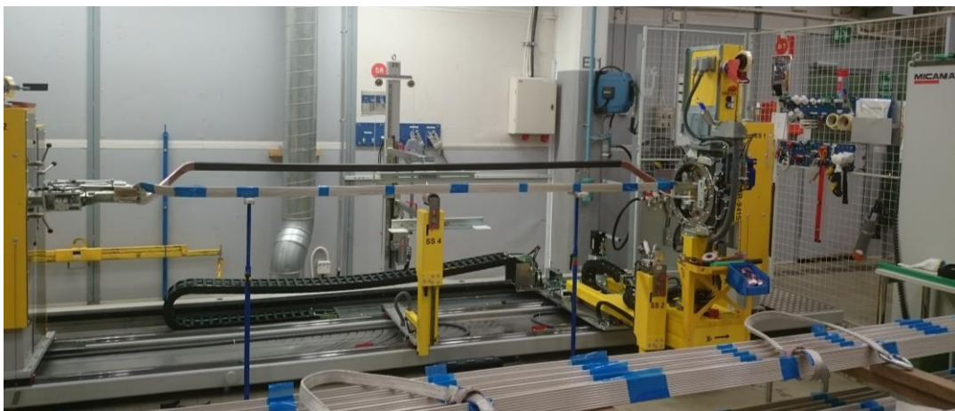
Kuva 8: Toiselta sivultaan eristysnauhalla ja mustalla pintanauhalla eristetty vyyhti vyyhdeneristyskoneessa.
