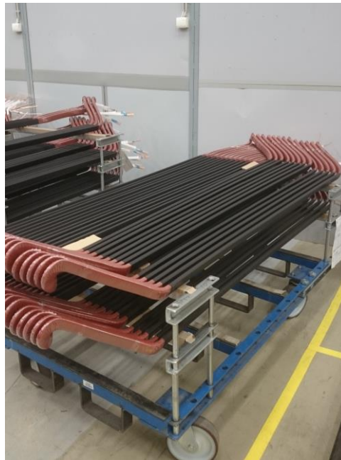
Kuva 9: Valmiita vyyhtejä kärryissä valmiina kuljetettavaksi seuraavalle osastolle. Kuvassa näkyy suoranosan musta johtavanauha, sekä päiden suojana oleva ruskea pintanauha.
