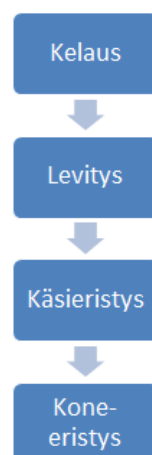
Kuva 10: Vyyhdenvalmistuksen prosessi pääpiirteittäin. Poikkeuksen tekevät Azipod-moottorit, joiden ehjä pää käsieristetään vasta koneeristuksen jälkeen.
