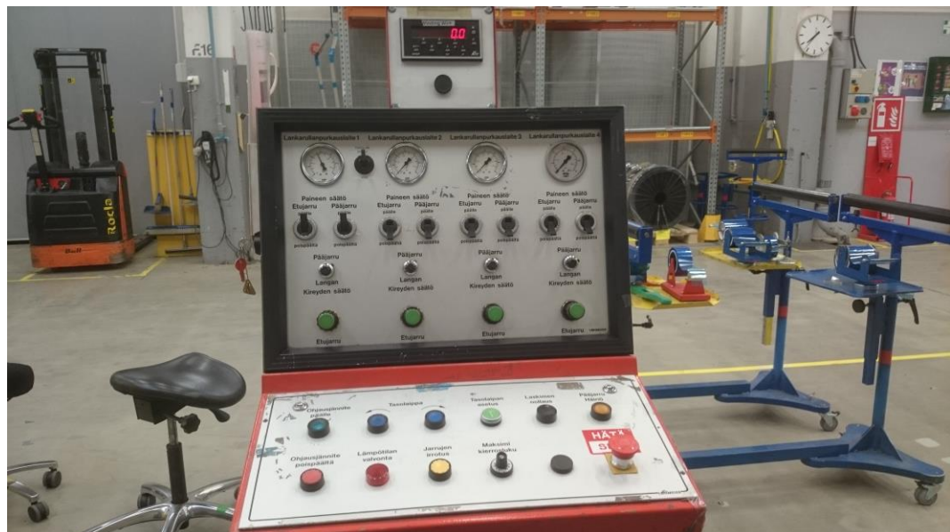
Kuva 15: Kelauskoneen ohjauspaneeli. Ylemmässä taulussa on jarrujärjestelmän hallintalaitteet. Alemmassa taulussa sijaitsevat itse kelauskoneen hallintalaitteet suunnan- ja nopeudensäätöineen. Ohjauspaneelin päällä olevalla laitteella säädetään kierrosluku.
