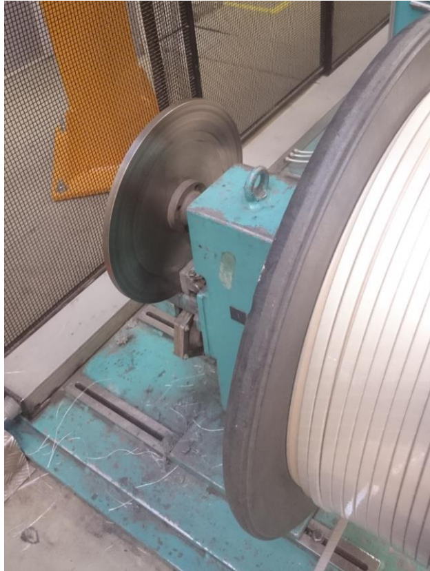
Kuva 13: Jokaisella akselilla on oma jarrujärjestelmänsä. Jarruilla varmistetaan sekä sopiva langan kireys, että kelan paikallaan pysyminen kelauspuomin ollessa pysähtyneenä.
