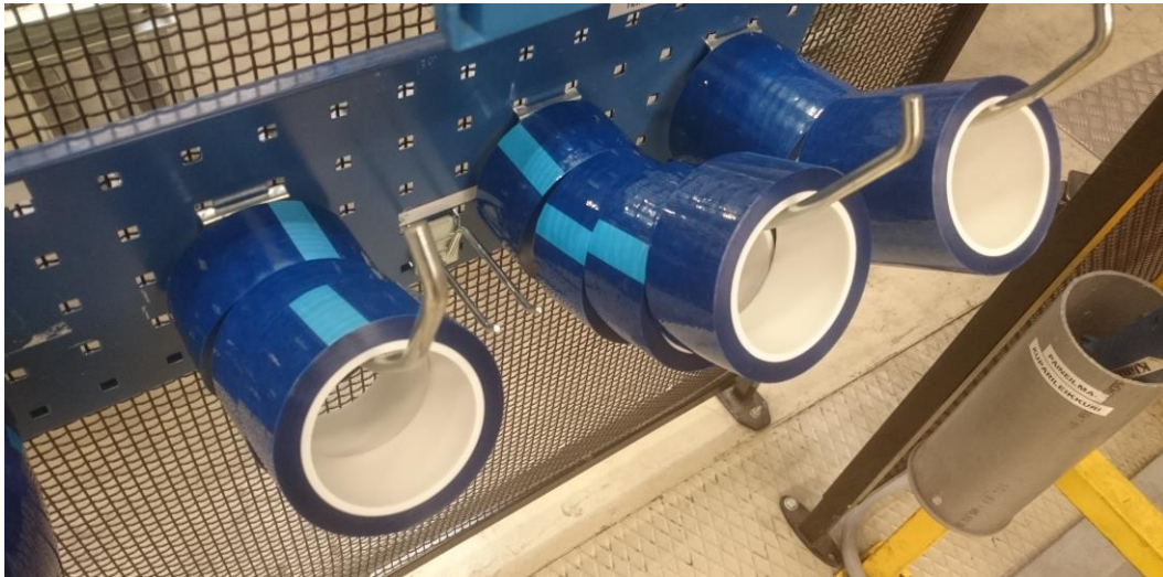
Kuva 11: Aihion teippaukseen käytetään erityisvalmisteista sinistä teippiä.
