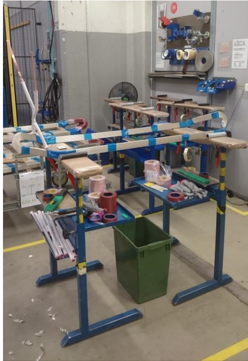
Kuva 7: Eristämätön vyyhti käsieristyspaikan pukeilla odottamassa eristysnauhan kietomista vyyhden kumpaankin päähän.
