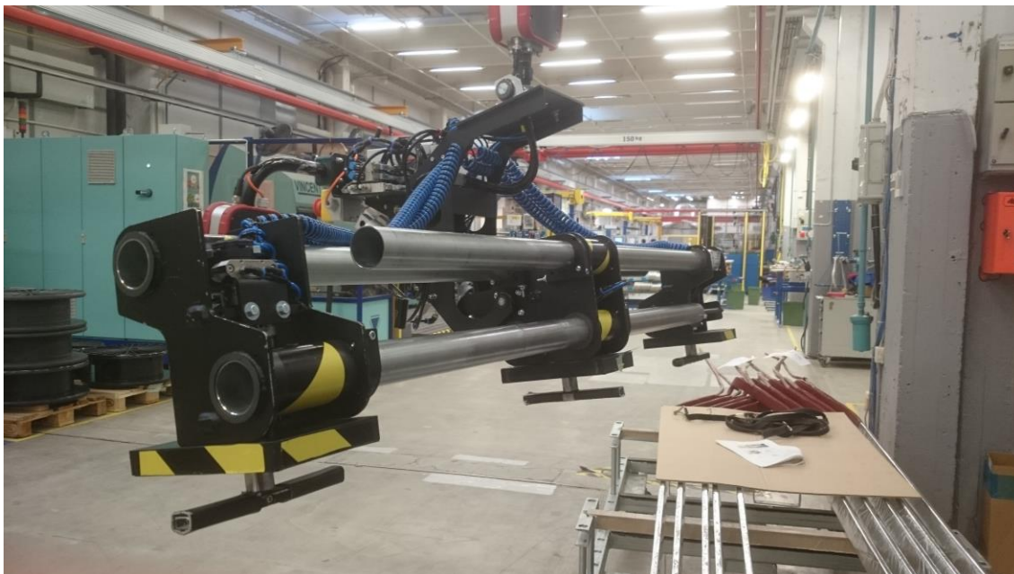
Kuva 19: Kuvassa olevalla keventimellä suurtakin aihiota voidaan nostaa ja siirtää yhden ihmisen toimesta.
