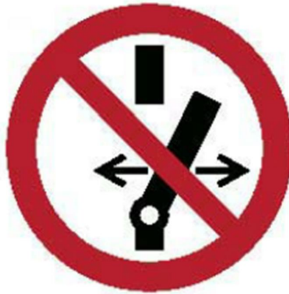
Kuva 2. Kielto-merkki kytkimen asennon muuttaminen kielletty (SFS 6002)
