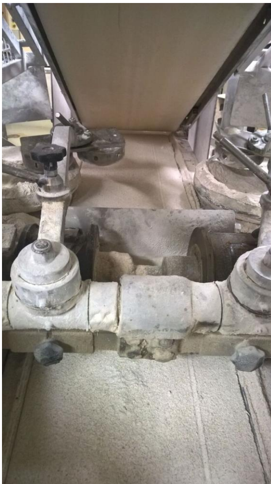
Kuva 4. Kanttikoneen sisällä olevat formut, jotka lyövät taikinamattoon leivän muodon.
