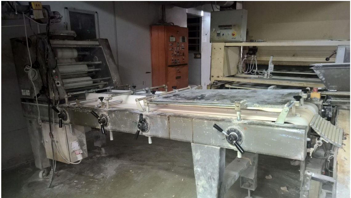
Kuva 6. 2-linjan litistäjä. Taikinapallot putoavat kuvassa vasemmassa reunassa olevaan koloon ja tulevat pihalle pitkulaisina kuvan oikeassa reunassa olevaa rullakkoa pitkin.
