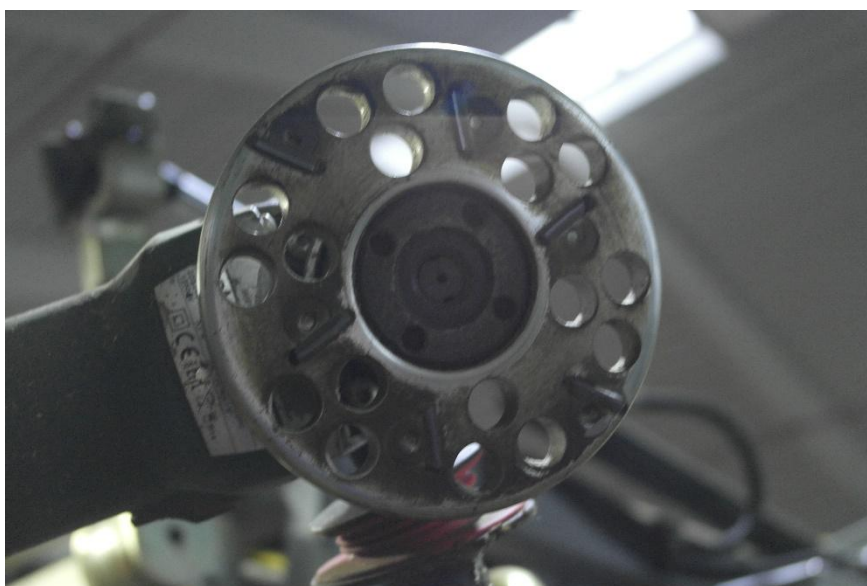
Bild 8. Ett vanligt bett till vinkelslipen med 6 blad. Foto: Anina Råstedt
