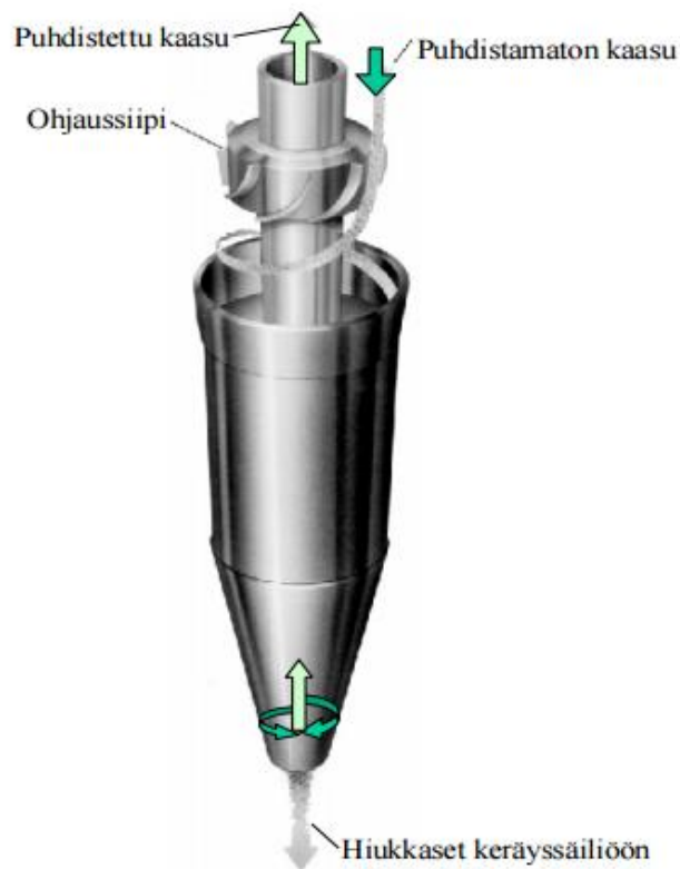
Kuvio 3. Vastavirtasyklonin toimintaperiaate (Ohlström ja muut 2005, 19)
