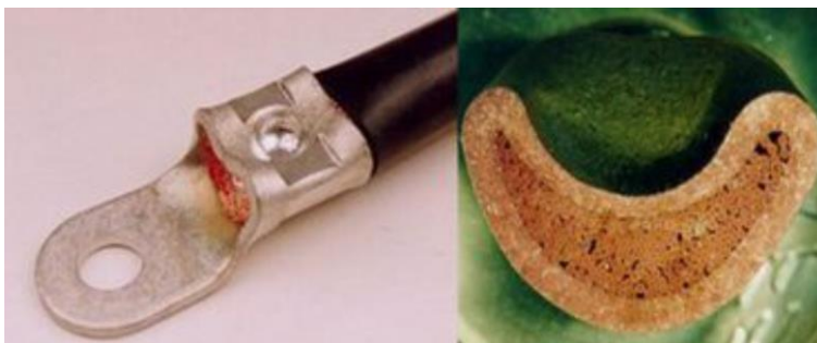
KUVA 8. Tuurnapuristettu levykaapelikengä (Remmel 2009)
