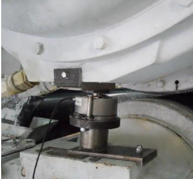
Kuvio 3. Voima-anturi nippitelojen laakeripesien välissä.
