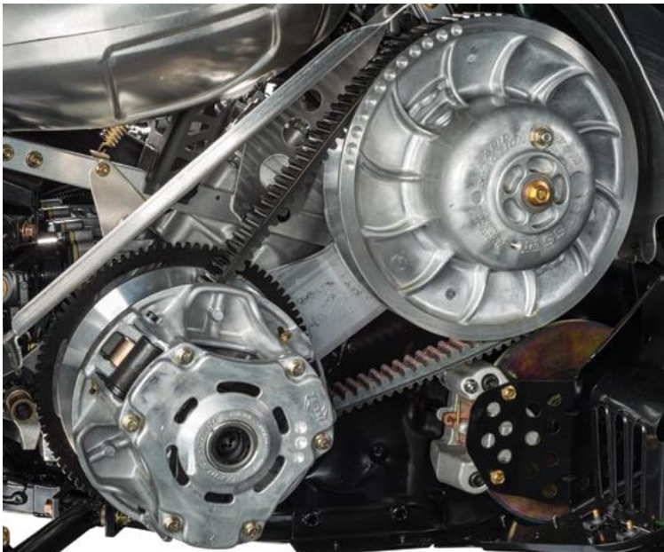
KUVA 1. Vasemmalla ensiovaraattori eli kytkin ja oikealla toisiovariaattori (2)
