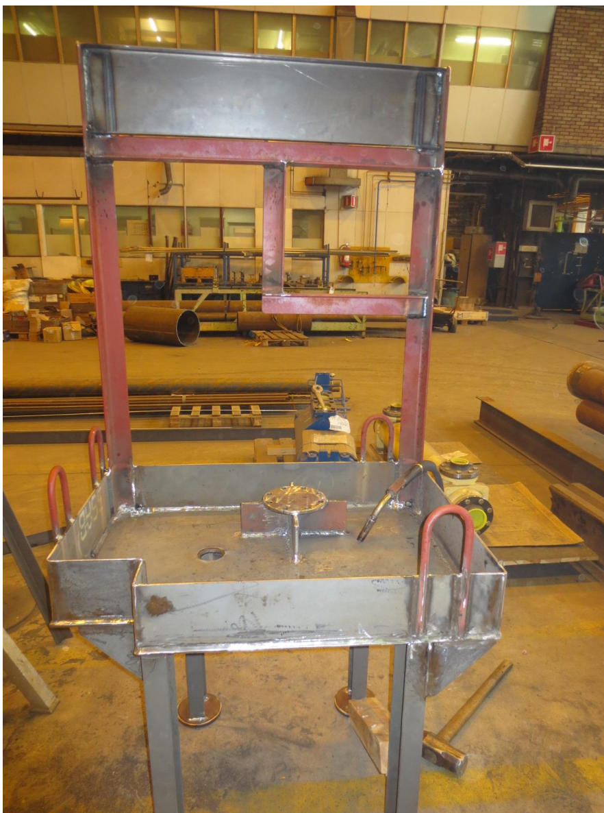
Kuva 9. Valmis vuotokaukalon runko [Juha Järvinen].
