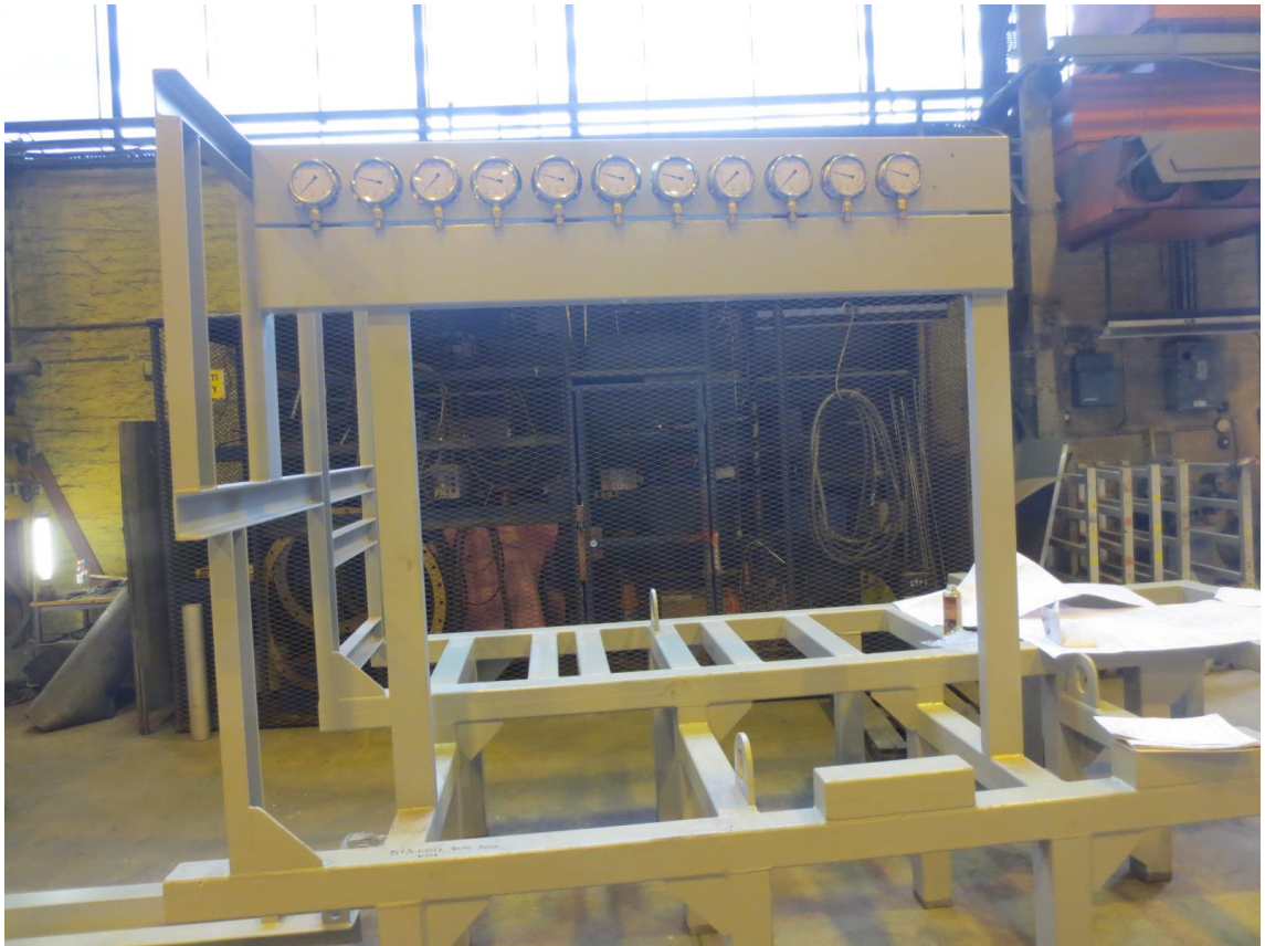
Kuva 15. Valmis runko ja siihen asennetut painemittarit [Juha Järvinen].
