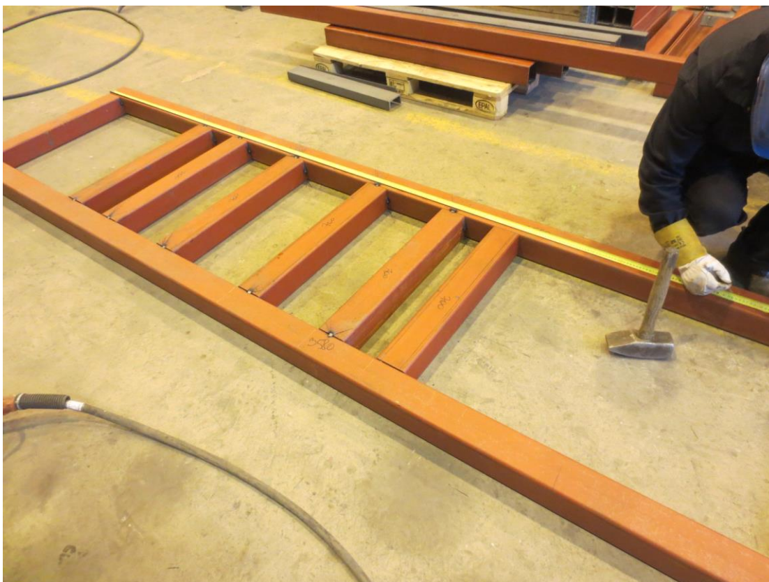
Kuva 14. Rungon muotorautojen mittausta ja asennusta [Juha Järvinen].
