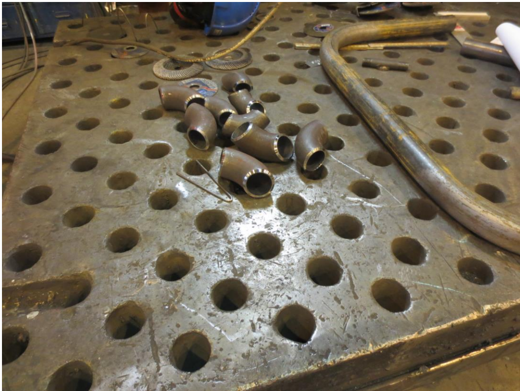
Kuva 10. Kulmahiomakoneella viistettyjä käyriä [Juha Järvinen].
