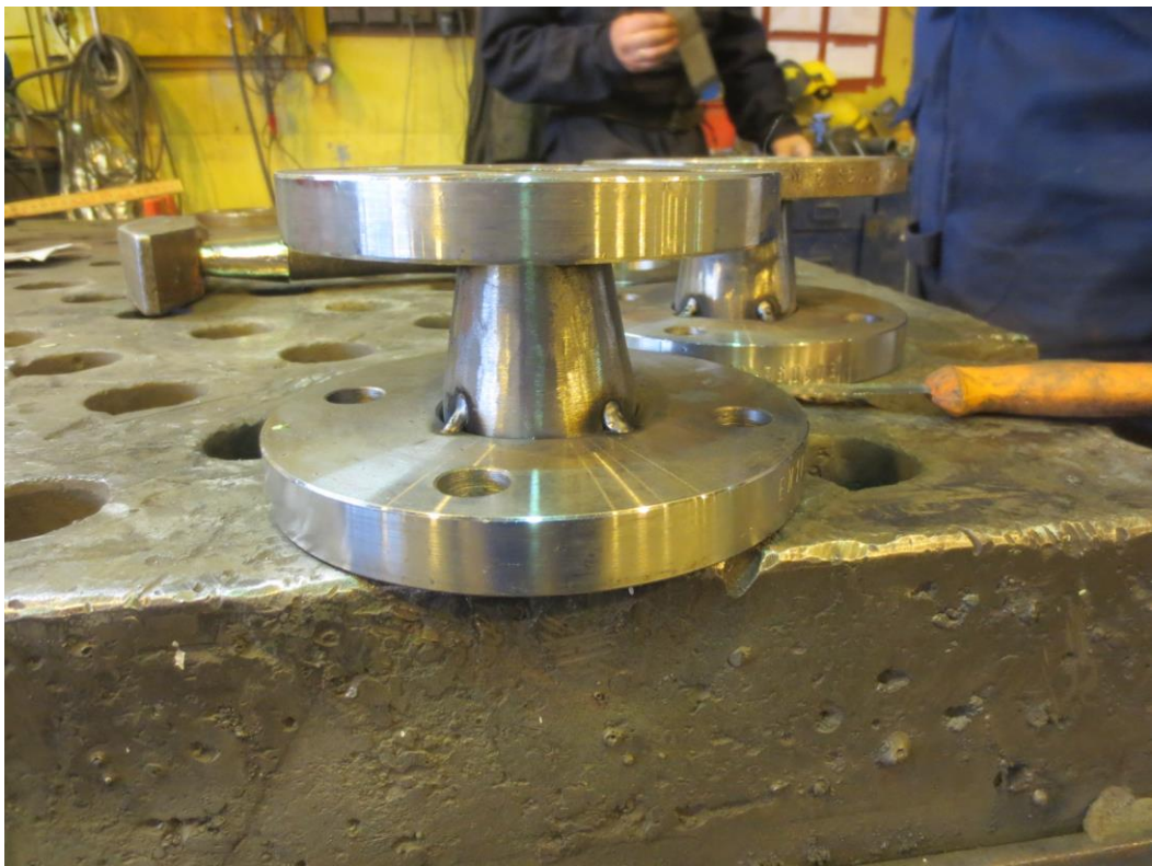
Kuva 11. DN50 ja DN30 laippa silloitushitsattuna supistajaan [Juha Järvinen].
