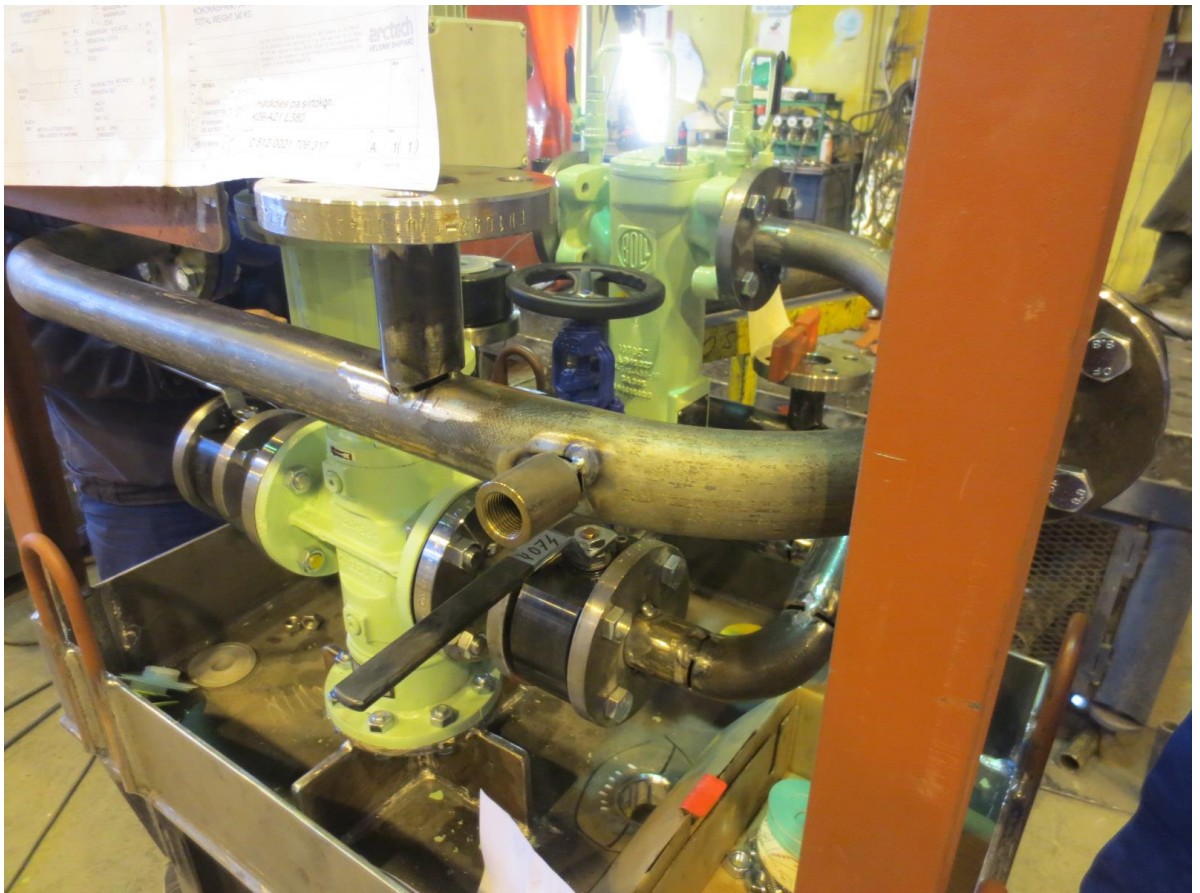
Kuva 18. Takana oleva vihreä suodatin kytkettynä väärinpäin [Juha Järvinen].
