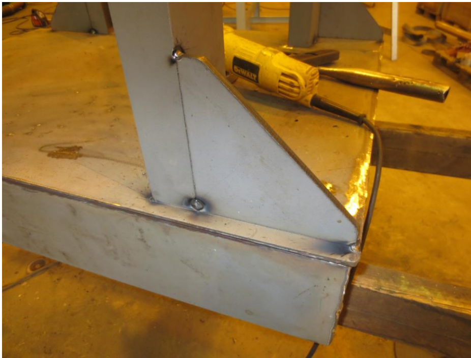
Kuva 7. Jalat ja polviot silloitushitsattuna alustassa [Juha Järvinen].
