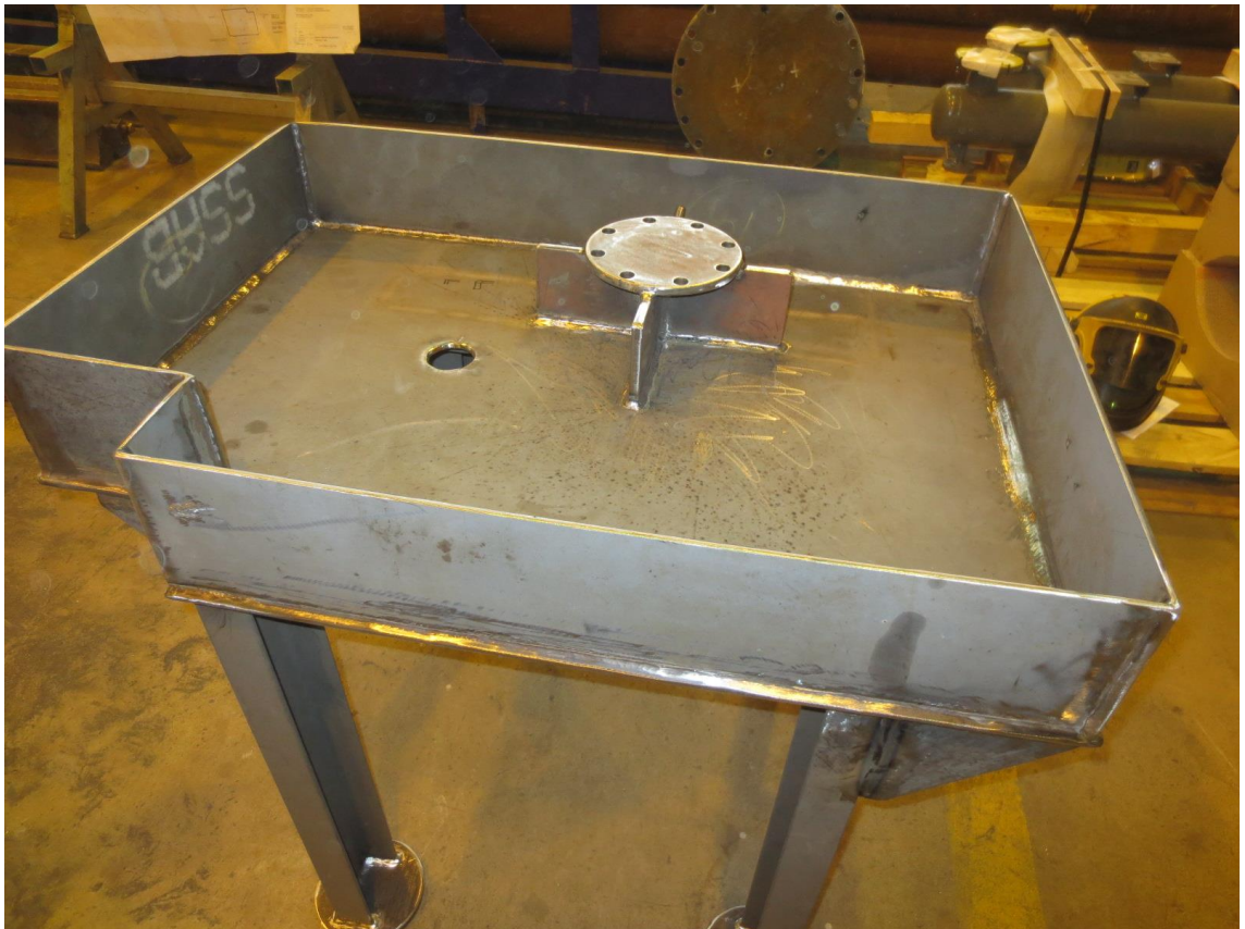
Kuva 20. Hiomisen jälki liian siistiä [Juha Järvinen].
