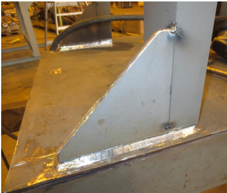
Kuva 8. Polvio sekä jalka hitsattuna ja hiottuna alustaan [Juha Järvinen].
