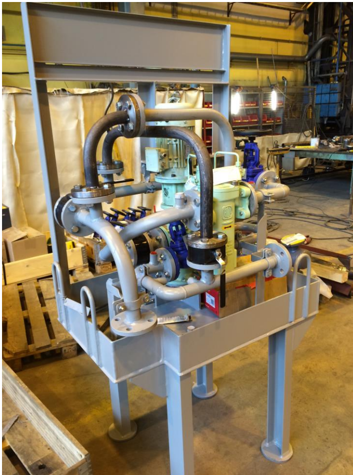
Kuva 13. Valmis hätädiesel-polttoaineen siirtokoneikko K09-A21 [Juha Järvinen].
