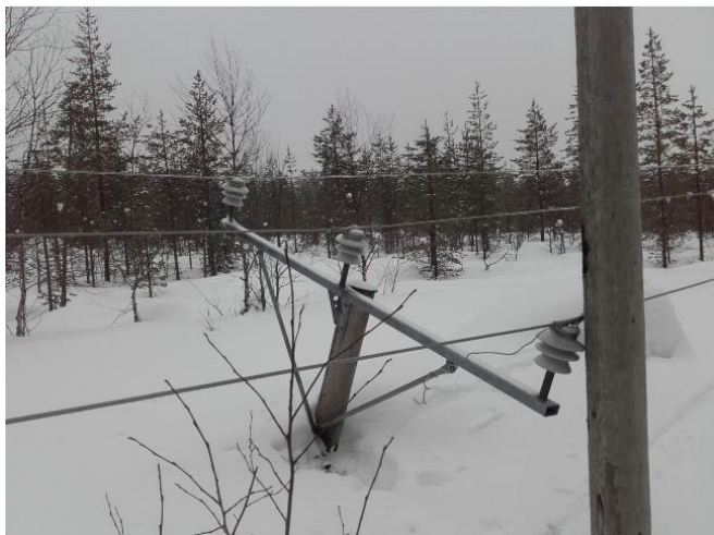
Kuva 3. Läpilyönti 20 kV tappieristemessä.
