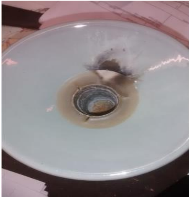
Kuva 3. Läpilyönti 20 kV tappieristemessä.
