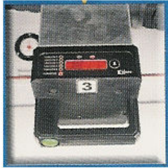
KUVIO 32. LED-näyttö paikantamisen apuna. (Projecta Oy 2004)
