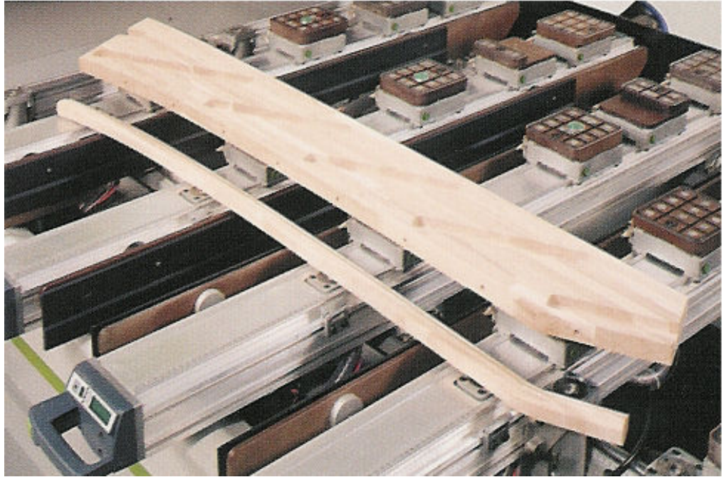
KUVIO 13. Kapeiden kappaleiden kiinnittäminen (Penope Oy 2004)
