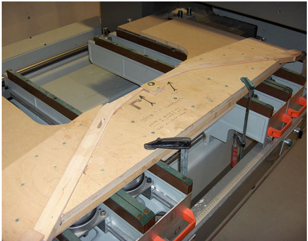
KUVIO 20. Kapeissa kappaleissa käytettävät jiggit (Koristepuu Tmi 2005)
