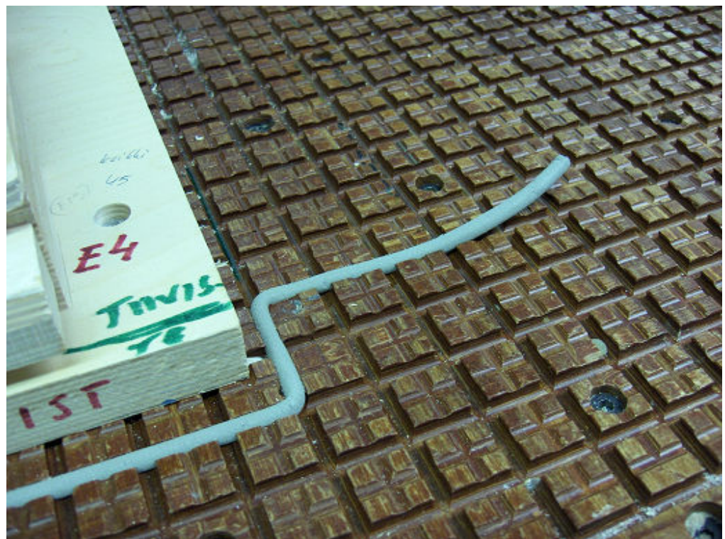
KUVIO 30. Kuva tiivistenauhasta, jolla voidaan rajata imualuetta (EFG Tuolituotanto Oy 2006)
