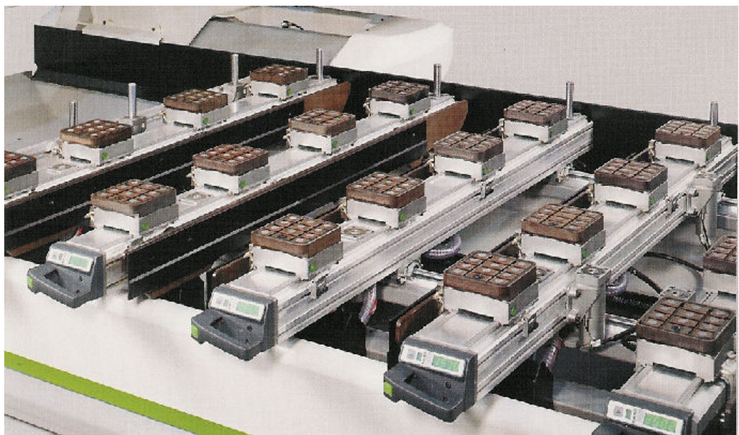
KUVIO 31. Liikutettavat palkit ja imukupit (Penope Oy 2004)
