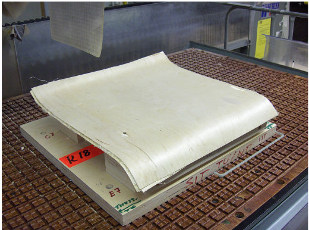
KUVIO 22. Muotopuriste kiinnitetty ajomallineella rasteripöytään (EFG Tuolituotanto Oy 2006)
