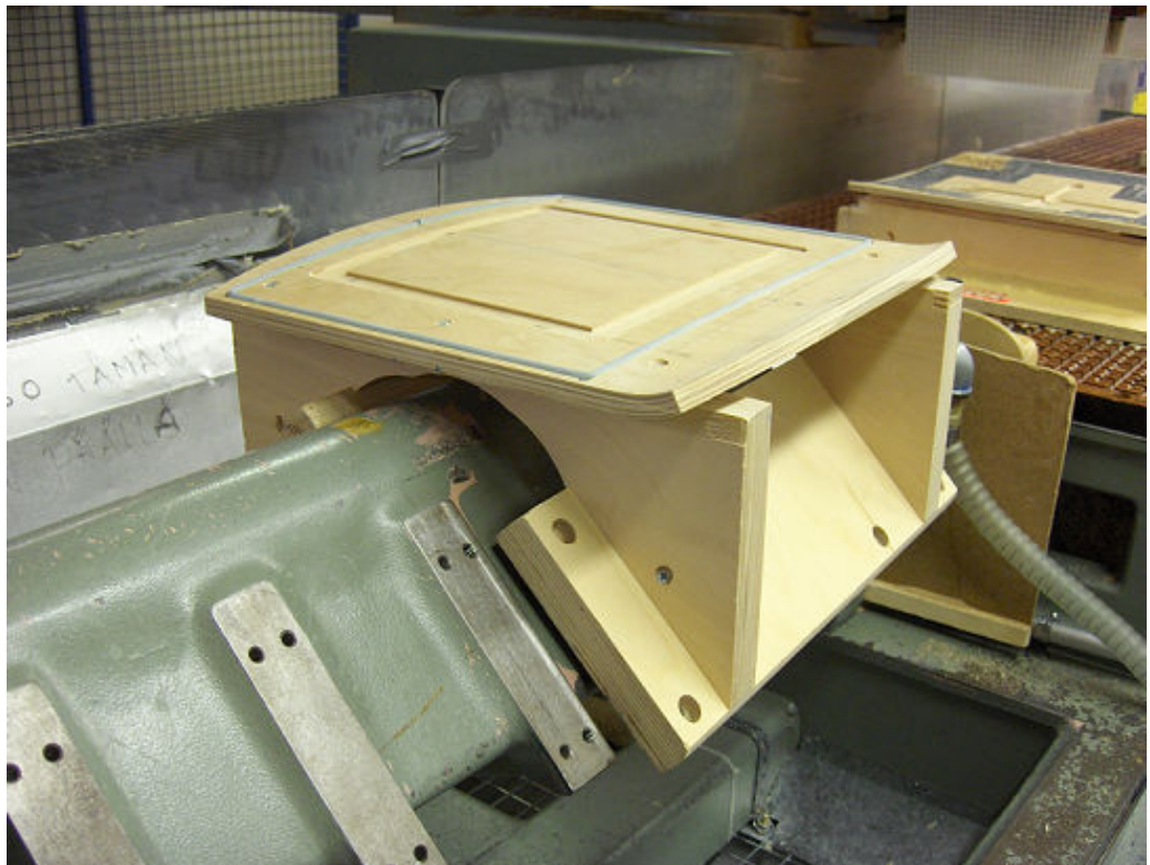
KUVIO 28. Muotopuriste kiinnitetty käännettävään tasoon (EFG Tuolituotanto Oy 2006)
