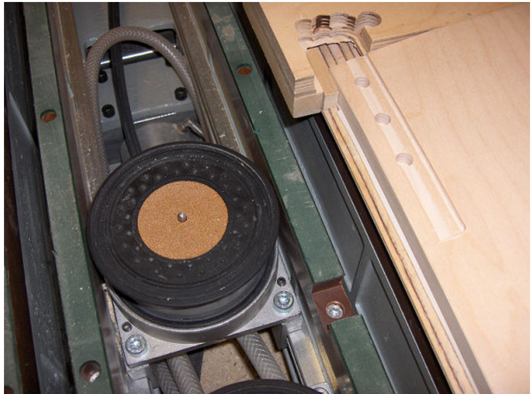
KUVIO 25. Ajomallineen kiinnittäminen imukuppien päälle. (Koristepuu Tmi 2005)
