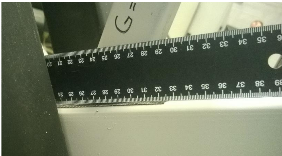
Kuva 17. Plastiset muodonmuutokset lähes eurokoodin kuormituskapasiteetilla. Vapaaväli 20 mm. (Kuva: Jere Konttila)
