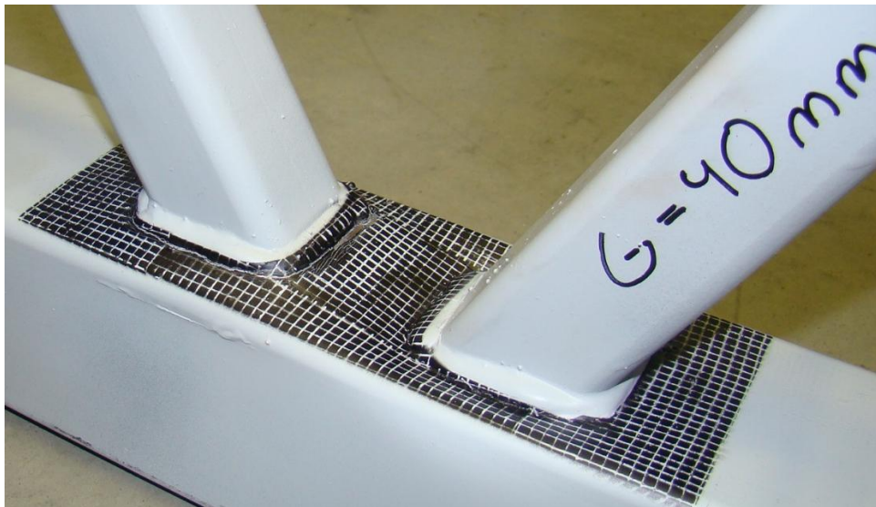
Kuva 10. K-liitos vapaaväliltään 40 mm. (Kuva: Jere Konttila)
