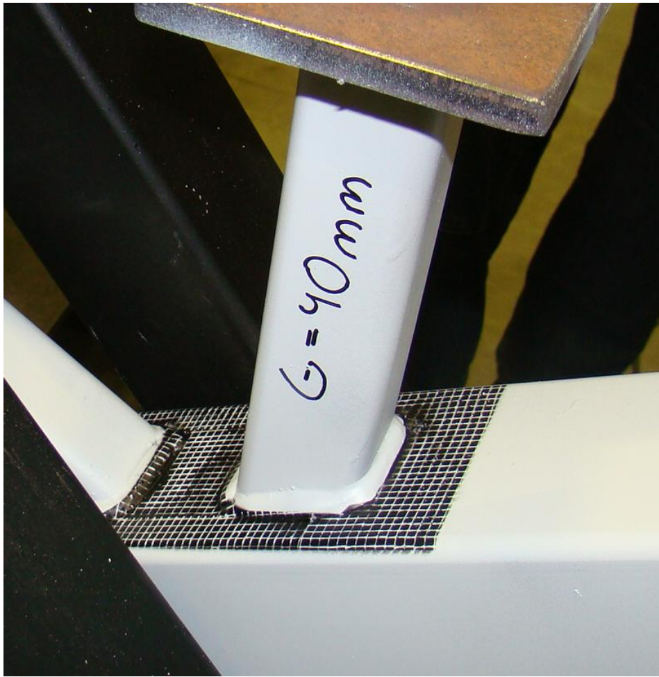
Kuva 8. Verkkokuvio havainnoinnin helpottamiseksi. (Kuva: Jere Konttila)
