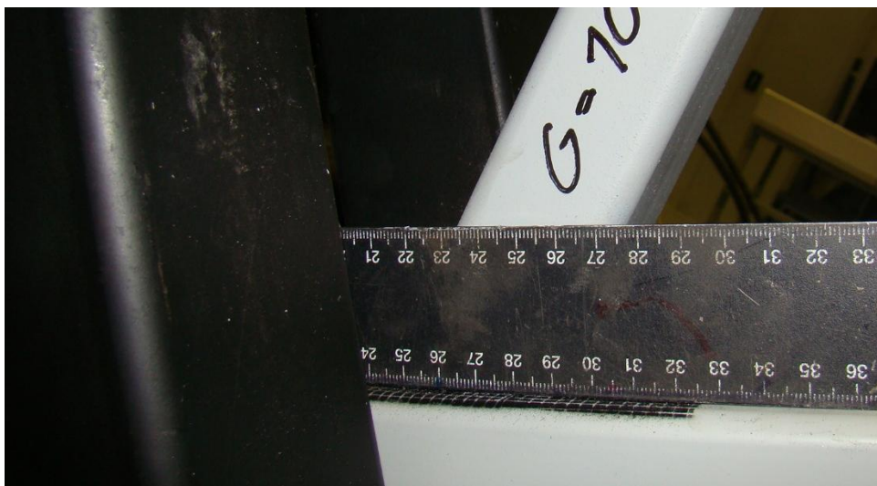
Kuva 22. Plastiset muodonmuutokset lähes eurokoodin kuormituskapasiteetilla. Vapaaväli 10 mm. (Kuva: Jere Konttila)
