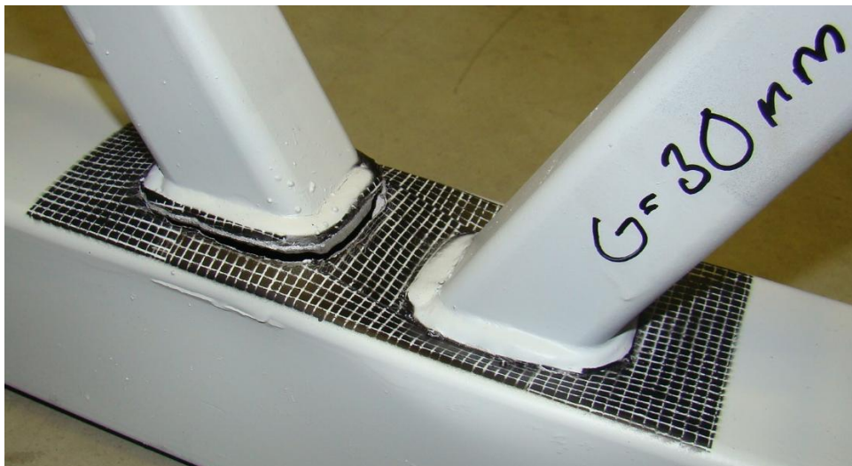
Kuva 12. K-liitos vapaaväliltään 30 mm, lopullinen murtuminen HAZ-alueessa. (Kuva: Jere Konttila)
