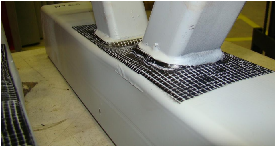
Kuva 11. Koekappaleen kyljen lommahdus. (Kuva: Jere Konttila)
