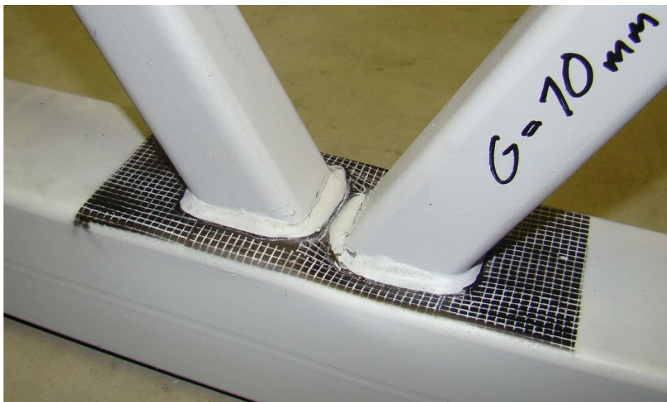
Kuva 19. Murtotapa vapaavälin ollessa 10 mm. (Kuva: Jere Konttila)
