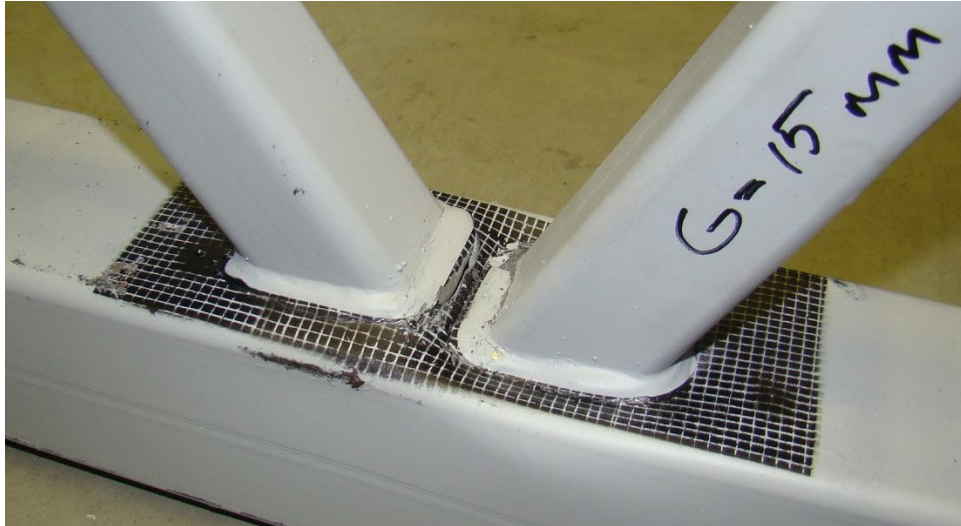
Kuva 18. Murotapa 15 mm:n vapaavälillä oli sama kuin mitoitusehto mukaisillakin kappaleilla. (Kuva: Jere Konttila)
