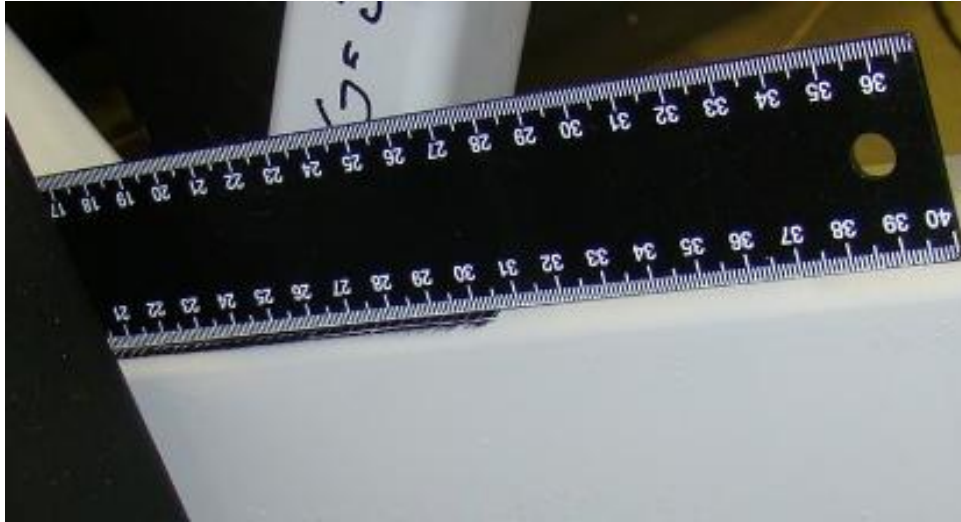
Kuva 16. Plastiset muodonmuutokset lähes eurokoodin kuormituskapasiteetilla. Vapaaväli 30 mm. (Kuva: Jere Konttila)
