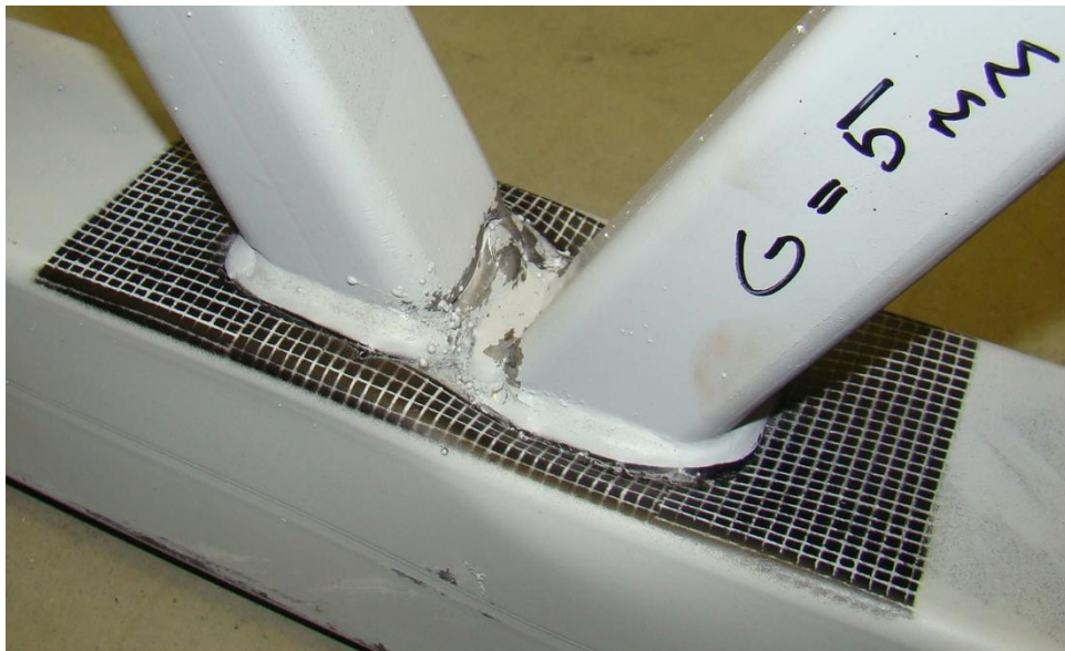
Kuva 20. Murtotapana vedetyn uumasauvan vetomurto HAZ-vyöhykkeeltä, kun vapaaväli oli vain 5 mm. (Kuva: Jere Konttila)
