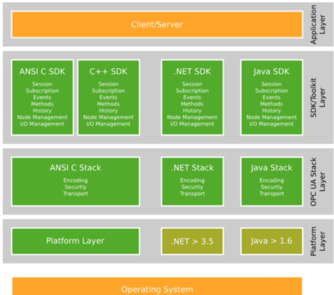
KUVA 23. SDK-yleiskuvas (Lähde:Unified Automation)
