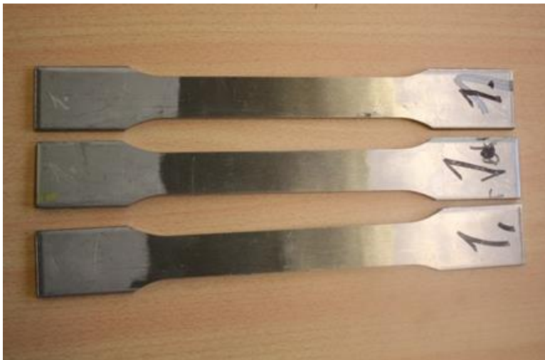
Kuva 2. Valmiita vetokoesauvoja, joista on hitsikuvut hiottu pois
