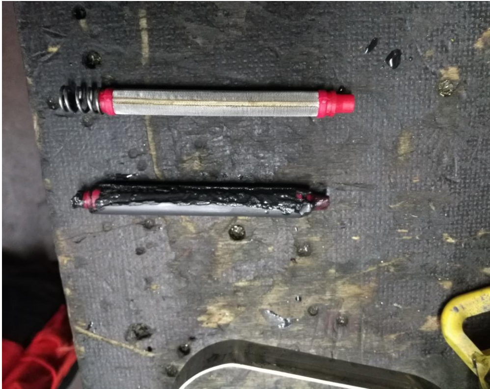
Kuva 4. Ensimmäisessä koeruiskutuksessa tukkeutunut suodatin.
