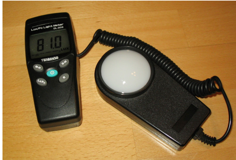
Kuvio 49. Tenmars DL-202 valaistusvoimakkuusmittari
