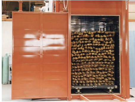
KUVIO 7. Perdure – lämpökäsittelymenetelmän kamari (PERDURE 2002)
